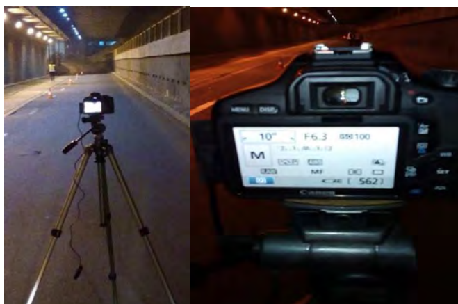
Figura 147 Măsurători de luminanță în tunelul TMK, cu trafic blocat
