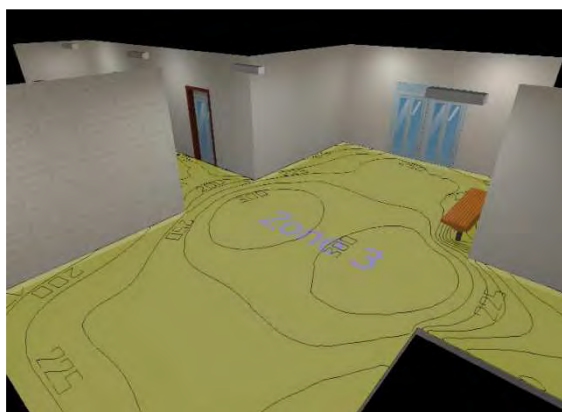
Figura 15 Designul clasic pentru sistemul de iluminat interior, cu iluminare orizontală (lux) pentru planul de lucru
