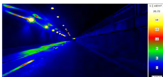
Figura 149 Distribuția luminanței în câmpul vizual în tunelul TMK
