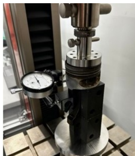
Fig. 7.6 Măsurarea parametrului deplasare în regiunea fusteii pistonului, cu ceasul comparator în prim cadru
