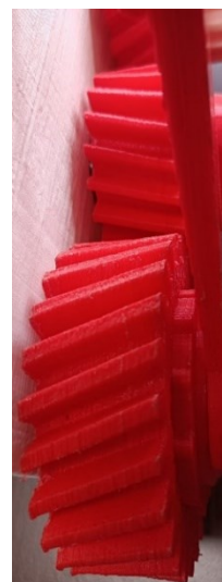
Fig. 7.3 Angrenajul de roți dințate, R_{d8} - R_{d9} , printat 3D, reprezentare în vedere izometrică
