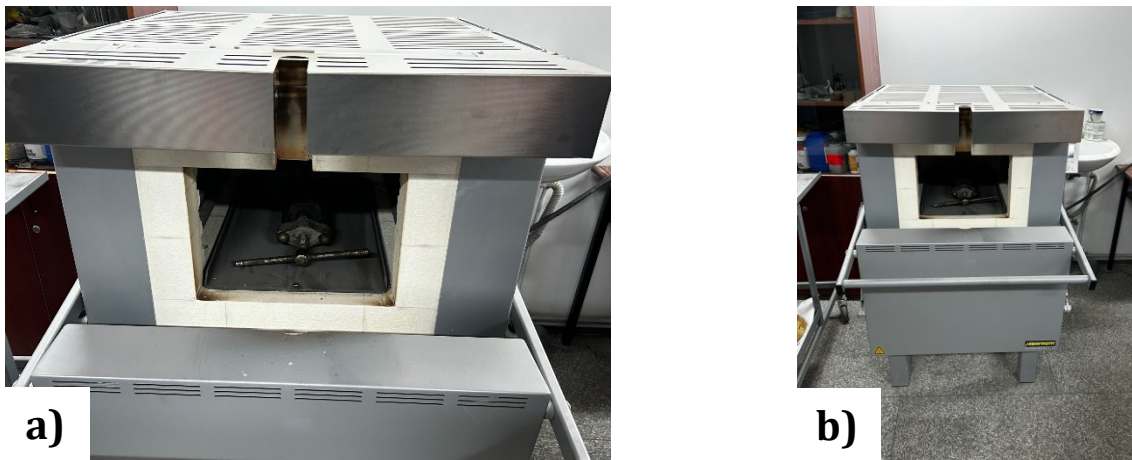
Fig. 7.12 a, b Poziționarea pistonului cu dispozitivul de fixare în incinta cuptorului a – vedere frontală a incintei cuptorului b – vedere frontală a cuptorului
