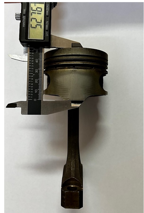
Fig. 7.2 Măsurarea lungimii pistonului
