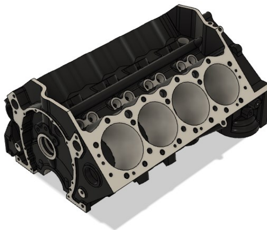
Fig. 4.29 Modelul tridimensional al blocului motor [19]
