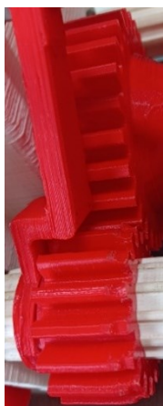
Fig. 7.2 Angrenajul de roți dințate, R_{d7} - R_{d8} , printat 3D, reprezentare în vedere izometrică
