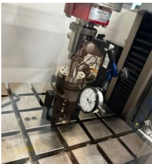
Fig. 7.5 Măsurarea parametrului deplasare în regiunea port segment, cu ceasul comparator și pistonul în prim cadru
