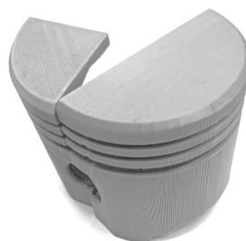
Fig. 7.1 a, b Pistonul printat 3D a - reprezentare în vedere izometrică b - reprezentare în secțiune
