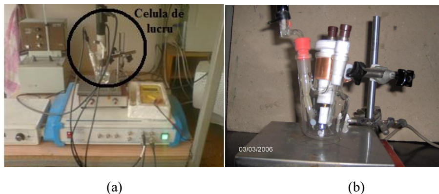
Figura 4.7. Echipament de investigare a coroziunii asupra materialelor metalice: (a) echipament potențiostat și (b) celula de lucru.
