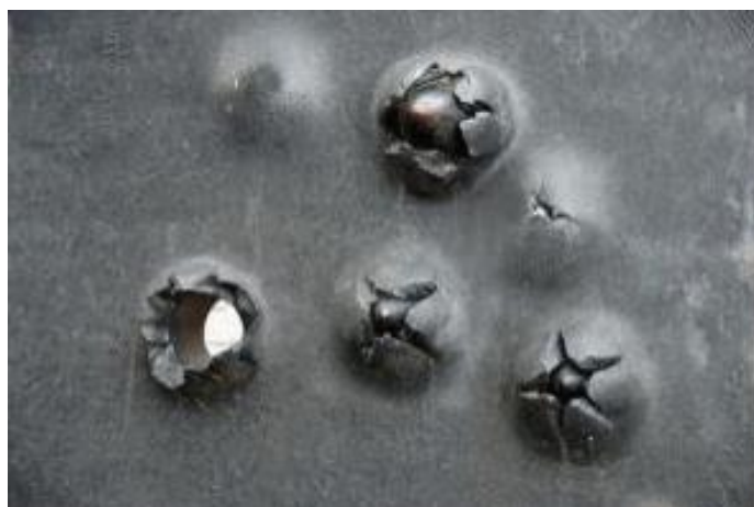
Figura 1.1. Placă de blindaj penetrată.
