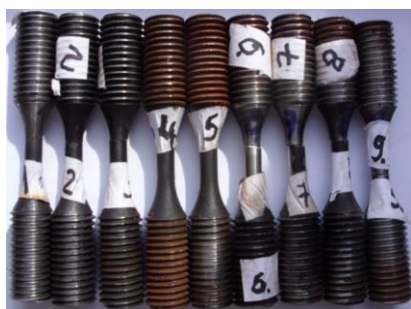
figura 3.15 Probele solicitate la oboseală din șina '86
