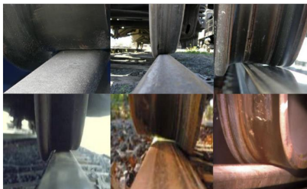
figura 1.48 Roată-șină neuzate (stânga sus) și roată-șină uzate (celelalte cazuri), (C. I. Bărbînță, 2014; Балановский, 2011)
