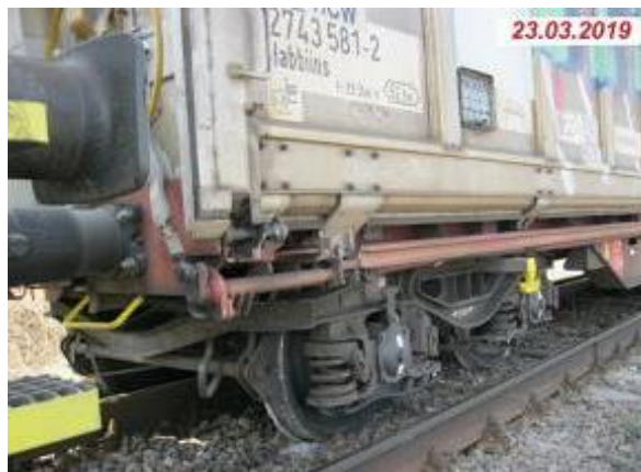
figura 1.33 Deraierea vagonului de marfă nr. 318127435812, (AGIFER, 2020d)
