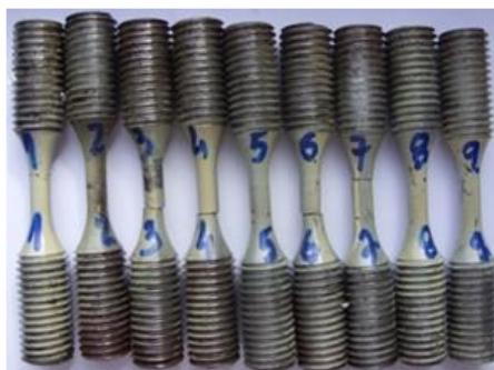
figura 3.14 Probele solicitate la oboseală din șina '85
