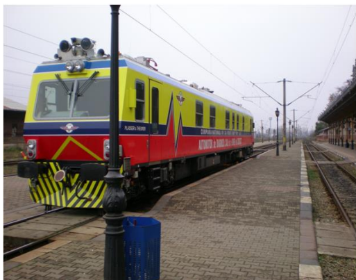
figura 1.30 Automotor de diagnoză a căii și a liniei de contact EM 130 R, (C. I. Bărbîntă, 2014)
