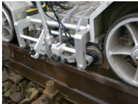
figura 1.31 Diagnosticarea zonei exfoliate folosind defectoscopul Dublu Sonatest Master-scan 380 pe Căruciorul RFD, (C. I. Bărbîntă, 2014)
