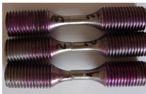
figura 3.16 Probele solicitate la oboseală din șina NOUĂ
