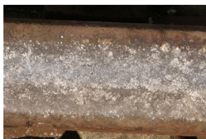
figura 1.49 Uzura șinei de cale ferată la trecerea de patru ori a roții pe suprafața de rulare, contactul fiind contaminat cu nisip
