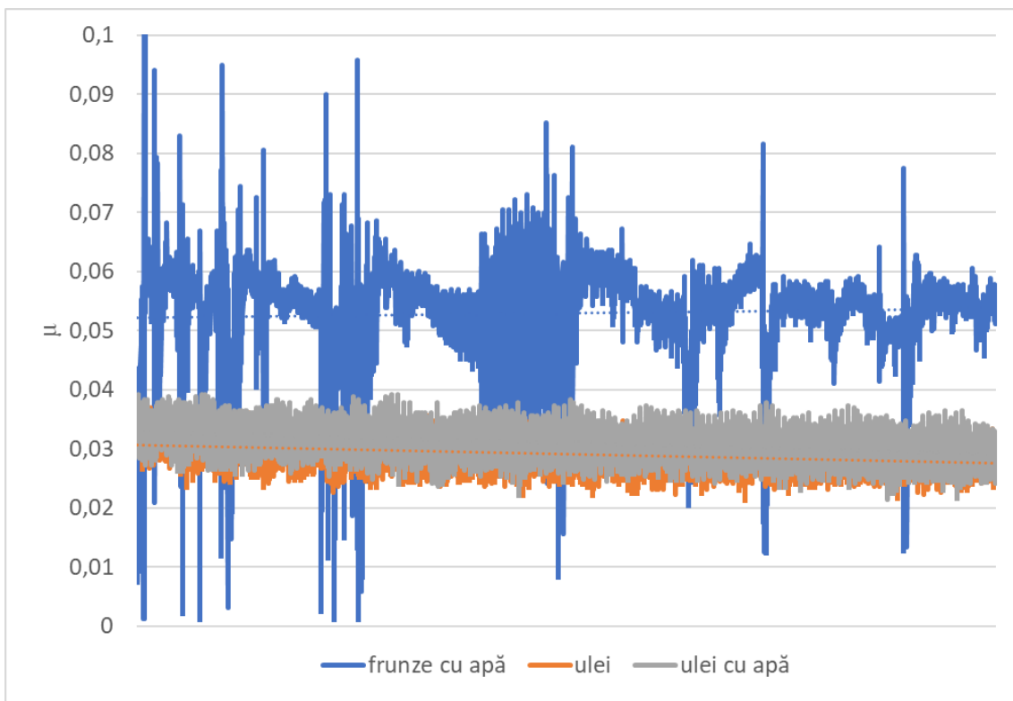
figura 3.28 Rezultatele măsurătorilor suprapuse privind coeficientul de frecare funcție de contactul contaminat cu frunze cu apă, ulei și ulei cu apă
