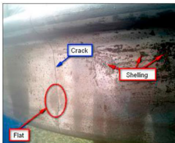
figura 1.43 Defecte întâlnite la roțile de cale ferată, care au condus la scoaterea roții din exploatare, (Zucarelli et al., 2016)
