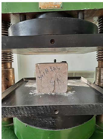
Figura 0.1. Determinarea rezistenței la compresiune cu o presă hidraulică
