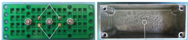
Figura 2.6. Microfon MEMS rezistent la factorii de mediu (praf, apă, etc.)
