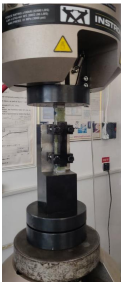
Fig. 2.31 a Dispozitivul de testare montat pe mașina de încercat INSTRON 8801
