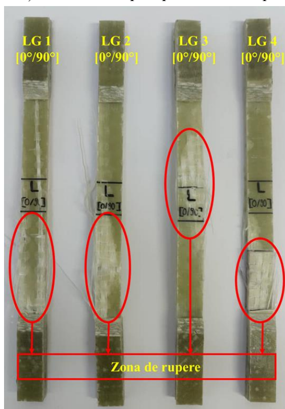
Fig. 2.8 Ruperea epruvetelor prelevate pe direcție longitudinală, cu orientarea fibrelor la [0°/90°]
