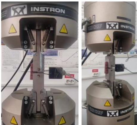
Fig.3.7 Tracțiunea pe mașina Instron a unei probe CT din GFRP
