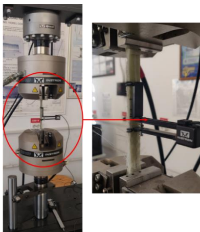
Fig. 2.3 Încercarea la tracțiune și detalii cu poziționarea extensometrului INSTRON -2670-112
