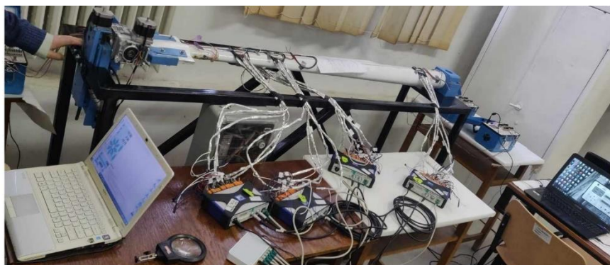
Fig. 6.10 Standul experimental în timpul testării palei de turbină eoliană
