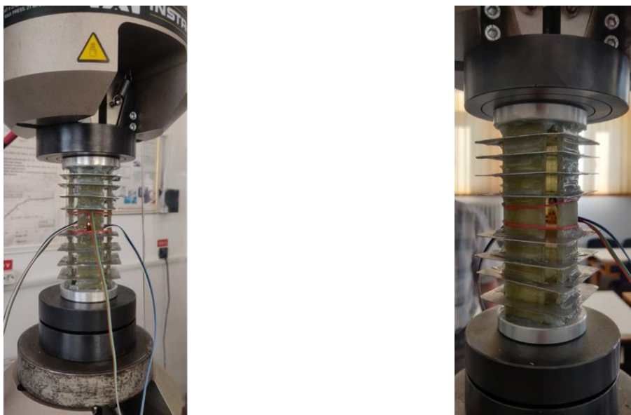
Fig. 2.37 Dispozitivul de testare și modul de așezare între platane pe mașina de încercat Instron 8801
