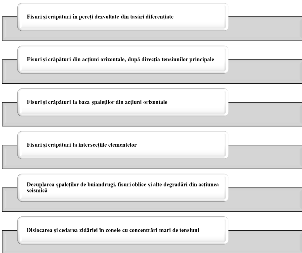
Figura 4 Determinarea avariilor caracteristice
