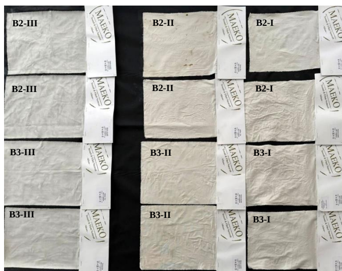
Figura 4.4. Mostrele de bambus plasate la uscat după tratarea cu biomaterial
