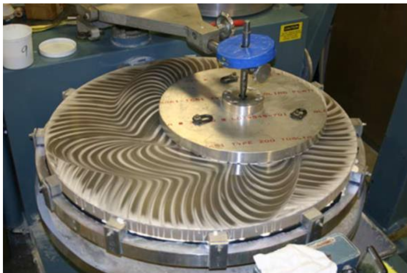
Fig. 1.9 – Mașină cu placă de lepuit [Suratwala , 2015]
