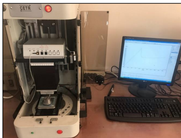
Fig. 3.1 – Vedere de ansamblu a echipamentului de testare UMT-2 pentru frecarea dintre materiale moi și sticlă
