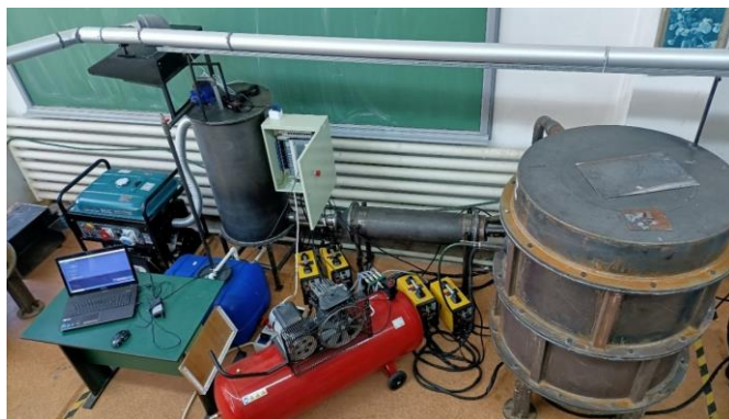
Figura 3.2. Instalație de conversie a deșeurilor cu plasmă cu hidrogen.
