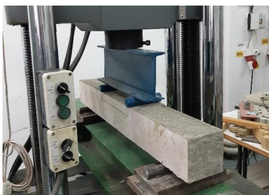
Figura 5.10. Încercarea la întindere prin încovoiere în patru puncte.
