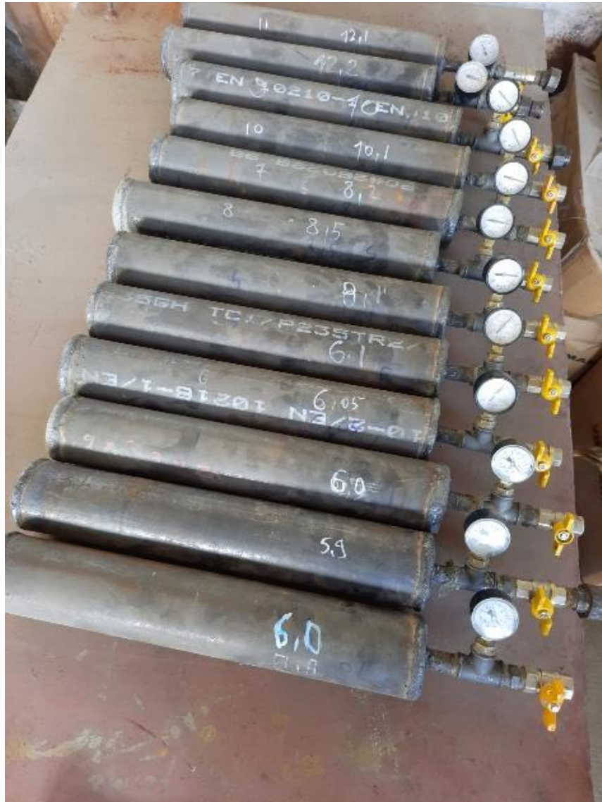
Figura 3.1. Eșantioanele pentru studiul efectului hidrogenului asupra conductelor de oțel
