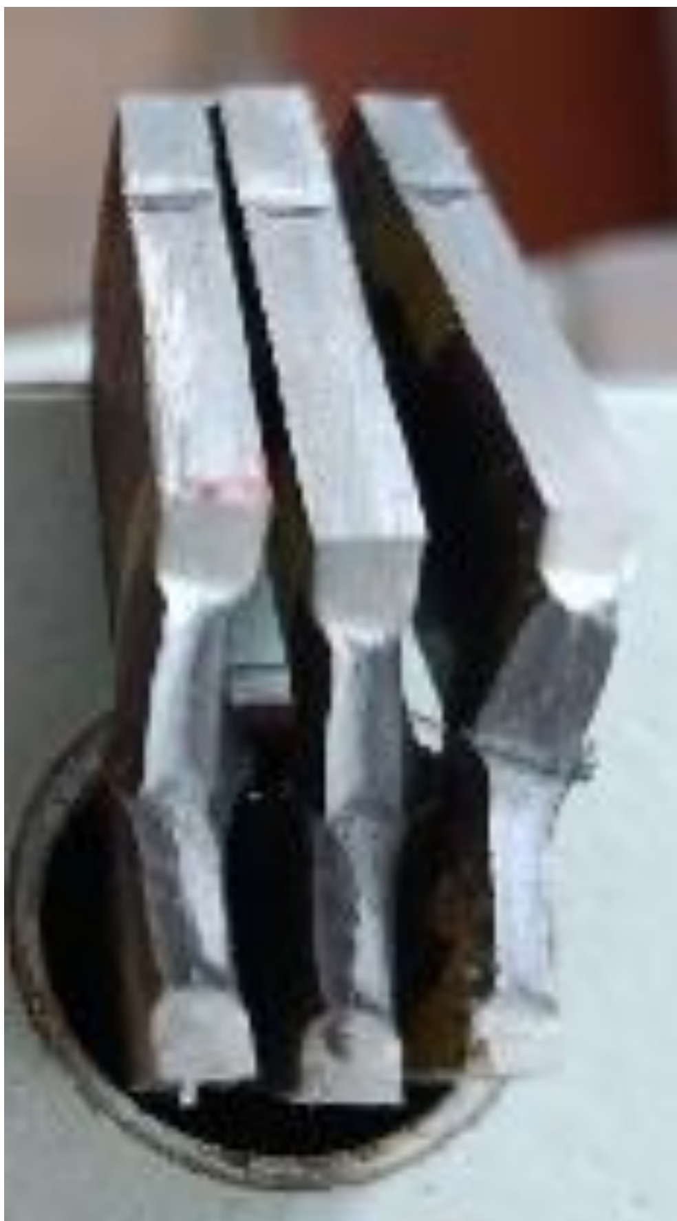
Figura. 3.5. Forma de rupere prin Șoc, la temperatura de 20 ° C, în cazul epruvetelor P 1
