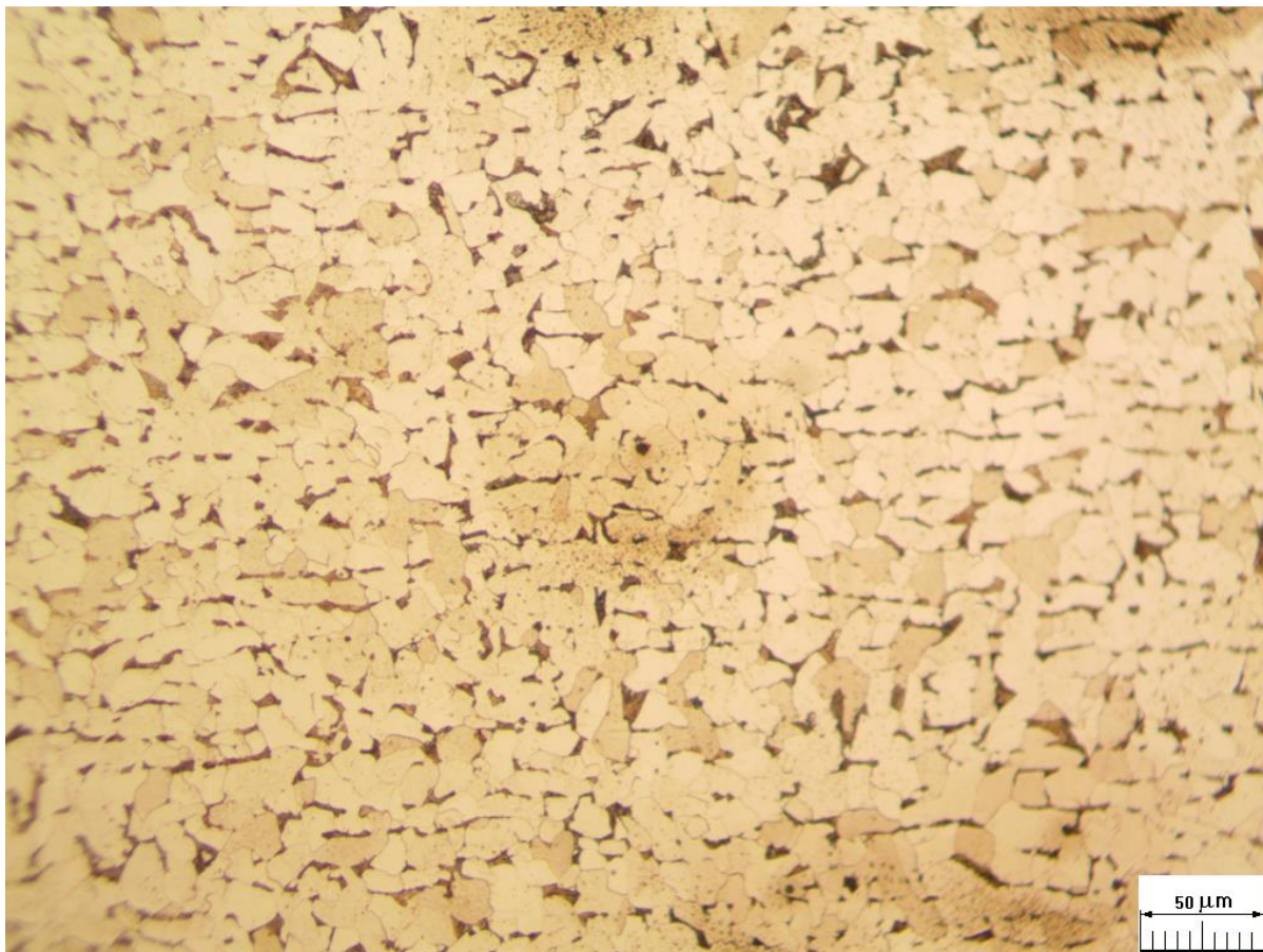
Figura. 3.34. Fotografierea prin microscopul metalografic a probei P10 supuse la hidrogen la scara 1x200
