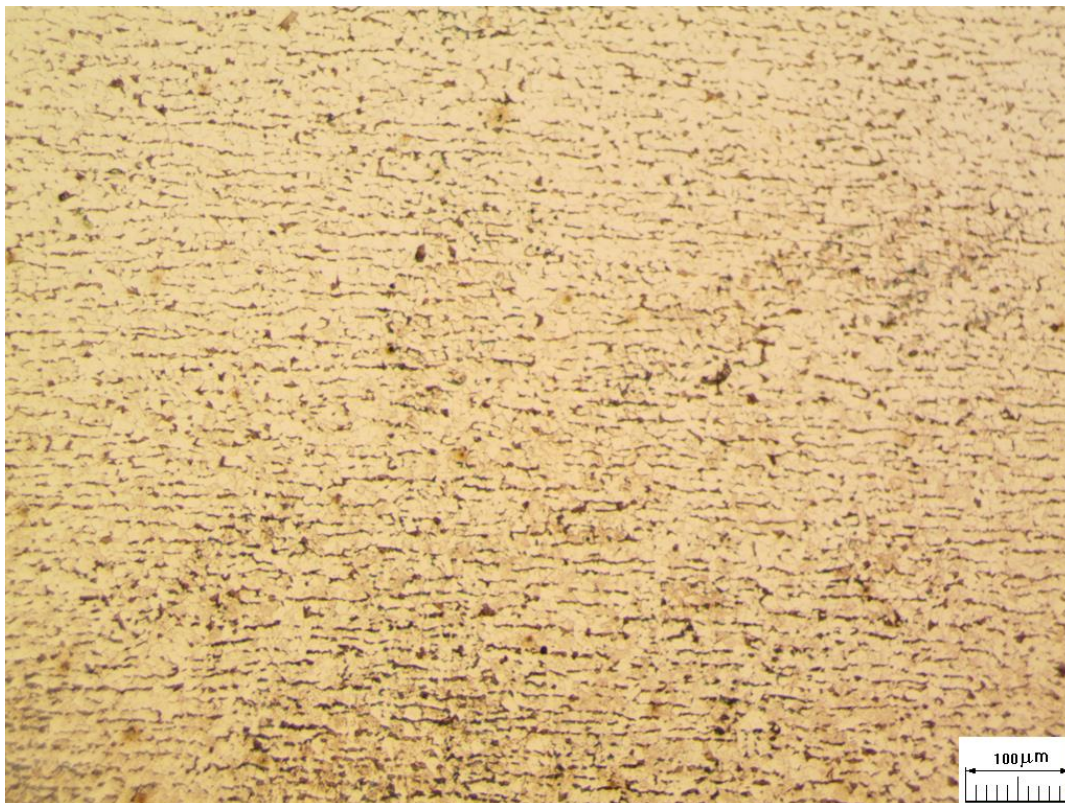
Figura. 3.24. Fotografierea prin microscopul metalografic a probei nesupuse la hidrogen la scara 1x100
