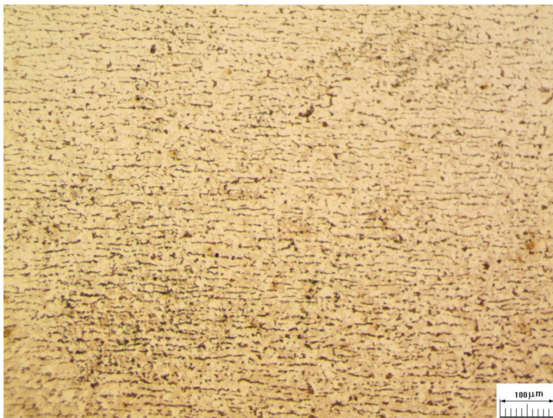
Figura. 3.28. Fotografierea prin microscopul metalografic a probei nesupuse la hidrogen la scara 1x100
