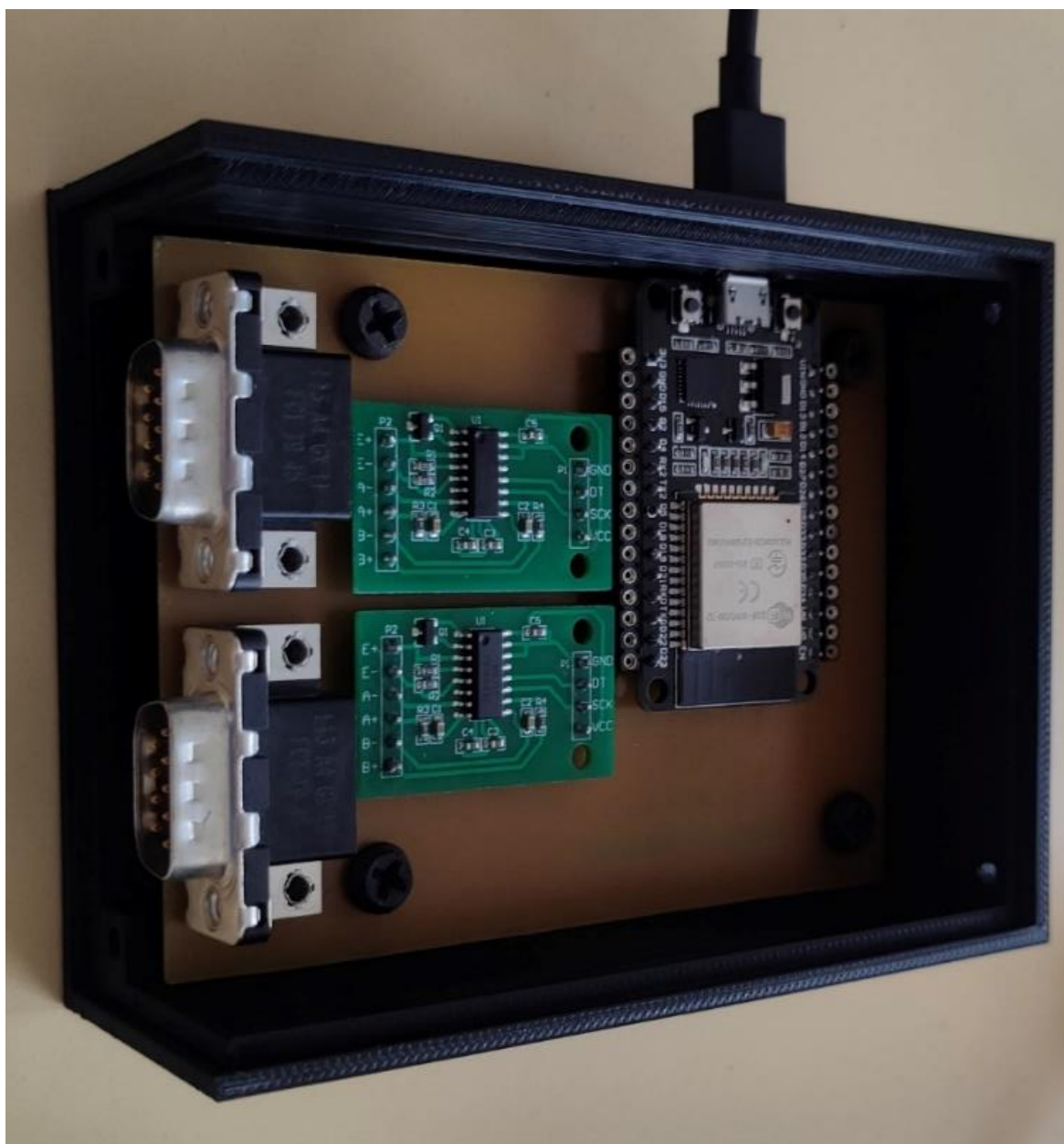
Figura 0.12 Asamblarea plăcii electronice în carcasă
