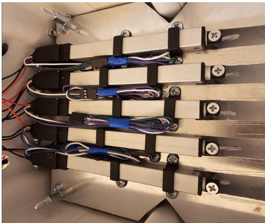
Figura 0.15 Actuatori liniar Actuonix (pentru fiecare deget).
