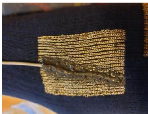
Figura 0.5 Lipirea cablurilor pe suprafața textiă a electrodului.
