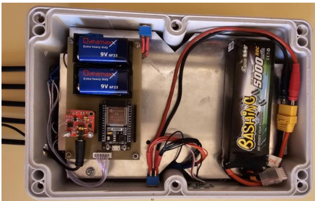
Figura 0.19 Interiorul dispozitivului MANUTEX-EMG.
