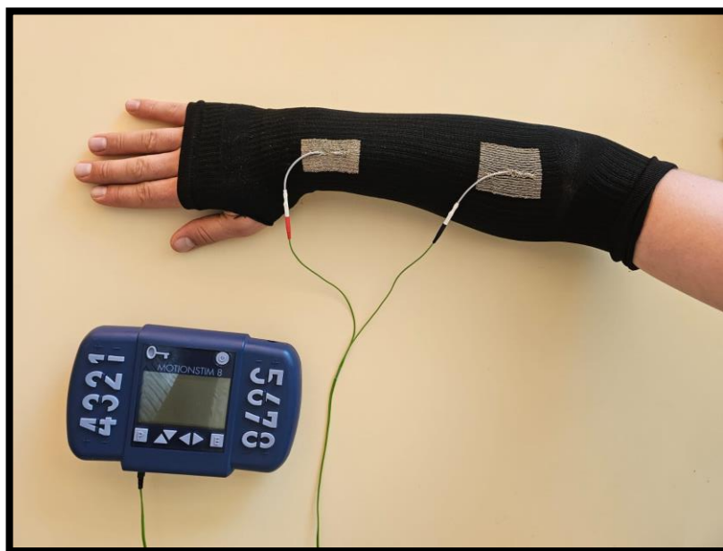
Figura 2 Mănușa textilă cu electrozi integrați conectată la neurostimulator.
