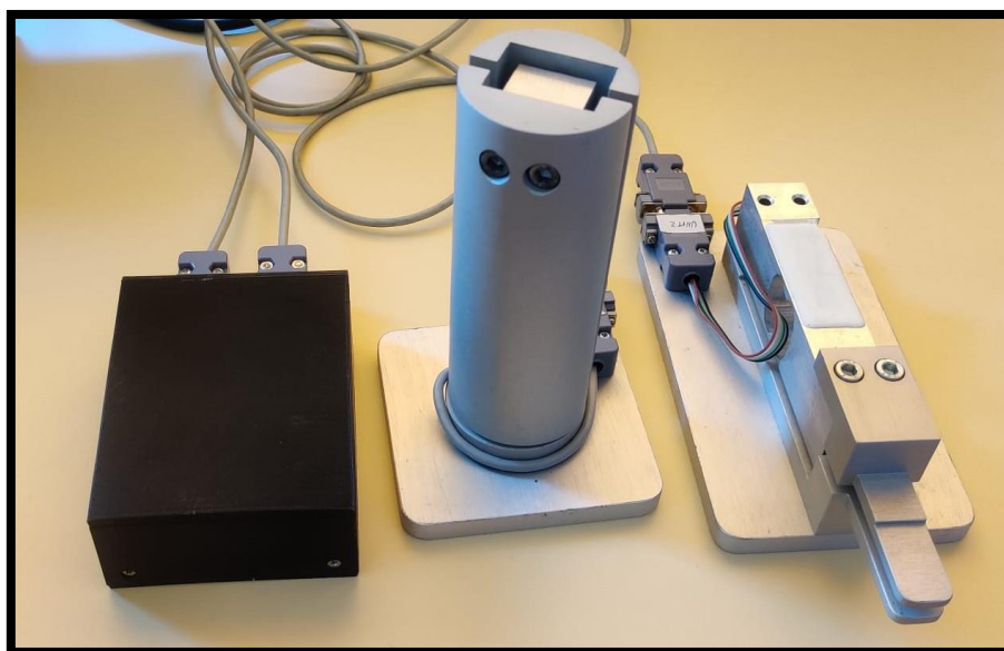
Figura 3 Dispozitive GFTSN cu senzorii de forță pentru ciupire în dreapta și pentru prindere în stânga (tip turn).
