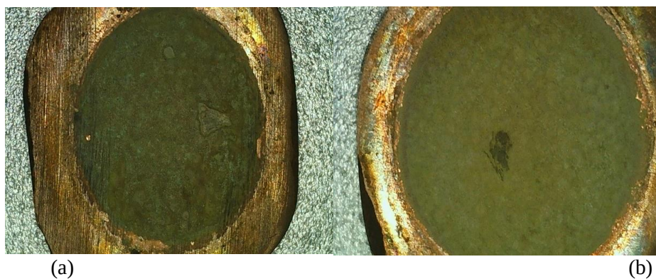
Figura 5.9. Microscopii optice ale suprafeței probelor după testul de rezistență la coroziune electro-chimică a) stare turnată și b) stare laminată
