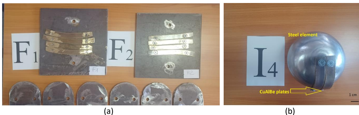
Fig. 3.13. Elemente pregătite pentru încercările la frecare în a) și la impact în b) în atmosferă explozivă.
