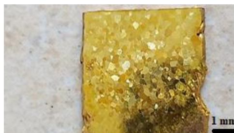
Figura 3.6. Diagrama schematică a procesului de laminare la cald a CuAlBe și microstructura (microscopie optică) înainte și după deformare în a), imaginea materialului înainte - ca lingou și după laminarea la cald ca placă în b) și diagrama tratamentului termic final al materialului laminat în c)
