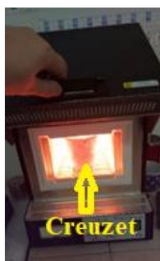
Figura 3.5. (a) Echipament de elaborare, un cuptor electric, (b) sistem de laminare la cald de laborator pentru plăci CuAlBe.
