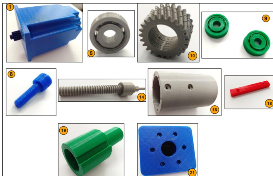
Fig. 6.9. Imagini cu componentele printate 3D cu ajutorul imprimantei Anet a8. Numerele asociate fiecărei imagini corespunde cu lista de materiale – BOM descrisă în figura 5.18
