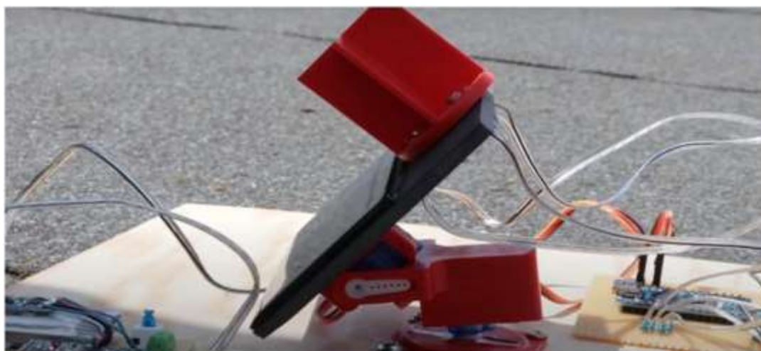
Figura 6.42 Montajul final al dispozitivului de urmărire de tip “tracker” solar
