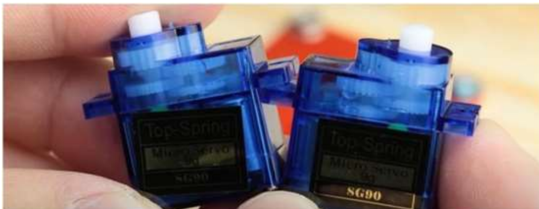
Figura 6.36 Testarea servomotorului înainte de realizarea montajului
