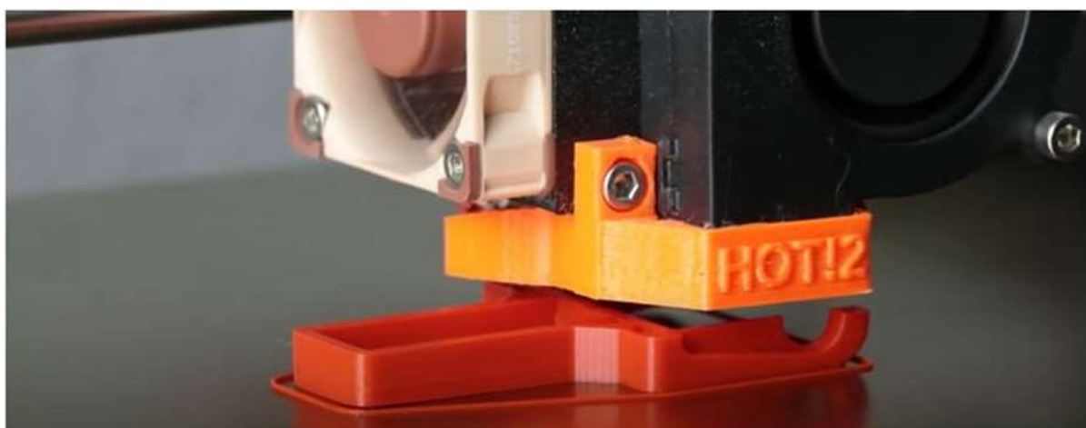
Figura 6.34 Printare 3D a dispozitivului de prindere
