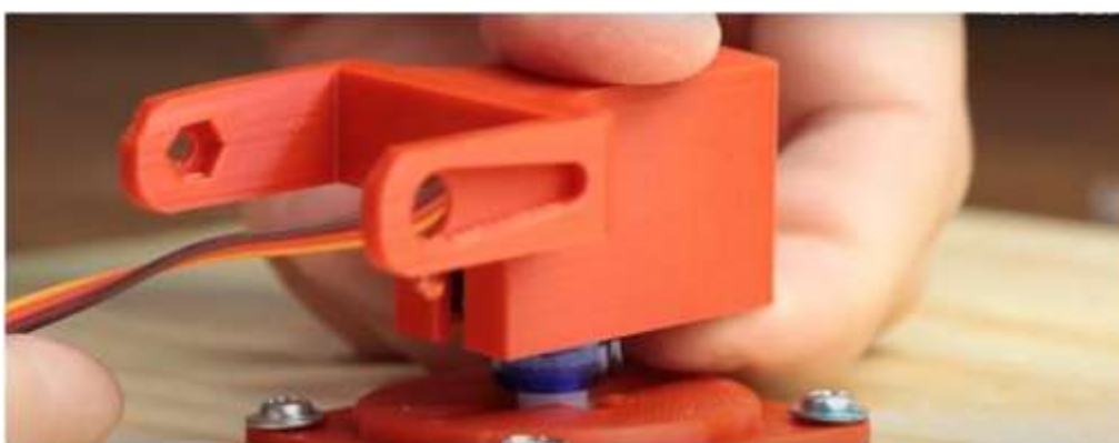
Figura 6.37 Fixarea servomotoarelor în suportul de ghidare
