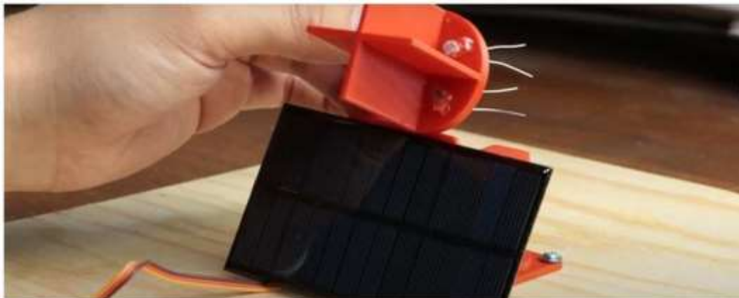
Figura 6.39 Montarea panoului solar și a fotorezistoarelor
