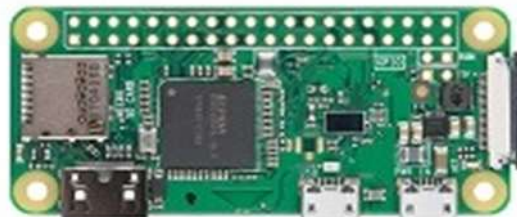
Figura 7.21. Placa de dezvoltare Raspberry Pi Zero W
