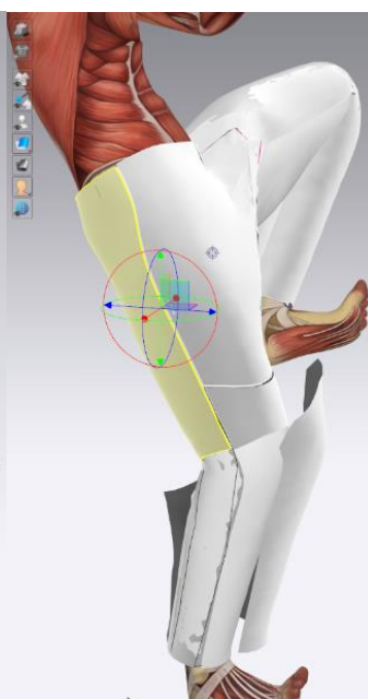
Figura 3. 11 Activarea funcției flatten pentru desfășurarea reperelor
