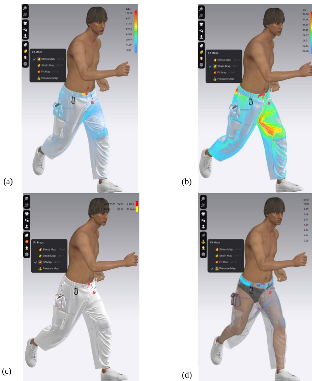
Figura 3. 19 Simularea și evaluarea comportamentului îmbrăcăminte la potrivire (a) tensiune; (b) deformare; (c) potrivire; (d) presiune.
