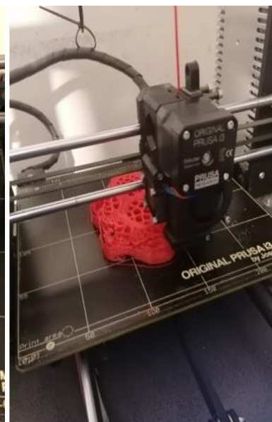
Figura 5. 7 Imprimare 3D cu filament TPE
