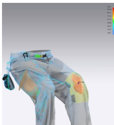
Figura 5. 17 Simulare – harta de deformare
