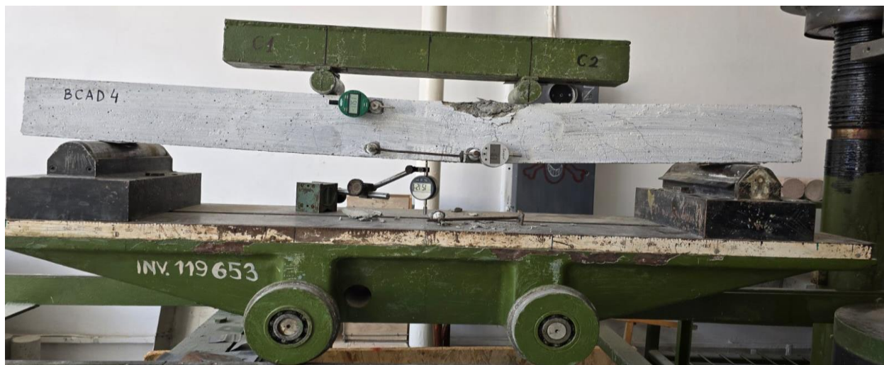
Fig.4.3.2.2. Testarea la încovoiere a grinzii din beton cu ABRD (BCAD4)
