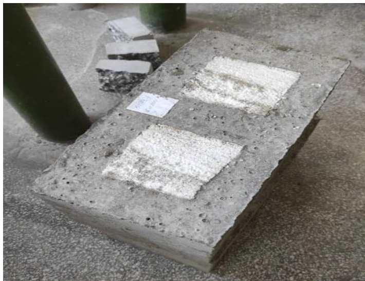
Fig.4.2.1.5. Blocuri cu goluri realizate din beton cu ABRD după decofrare
