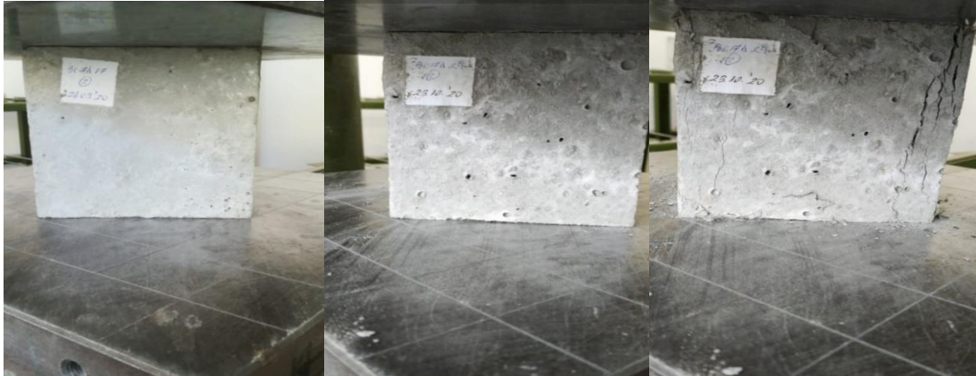
Fig. 3.5.2.1. Încercarea la compresiune și modul de cedare a epruvetelor de beton cu ABRD
