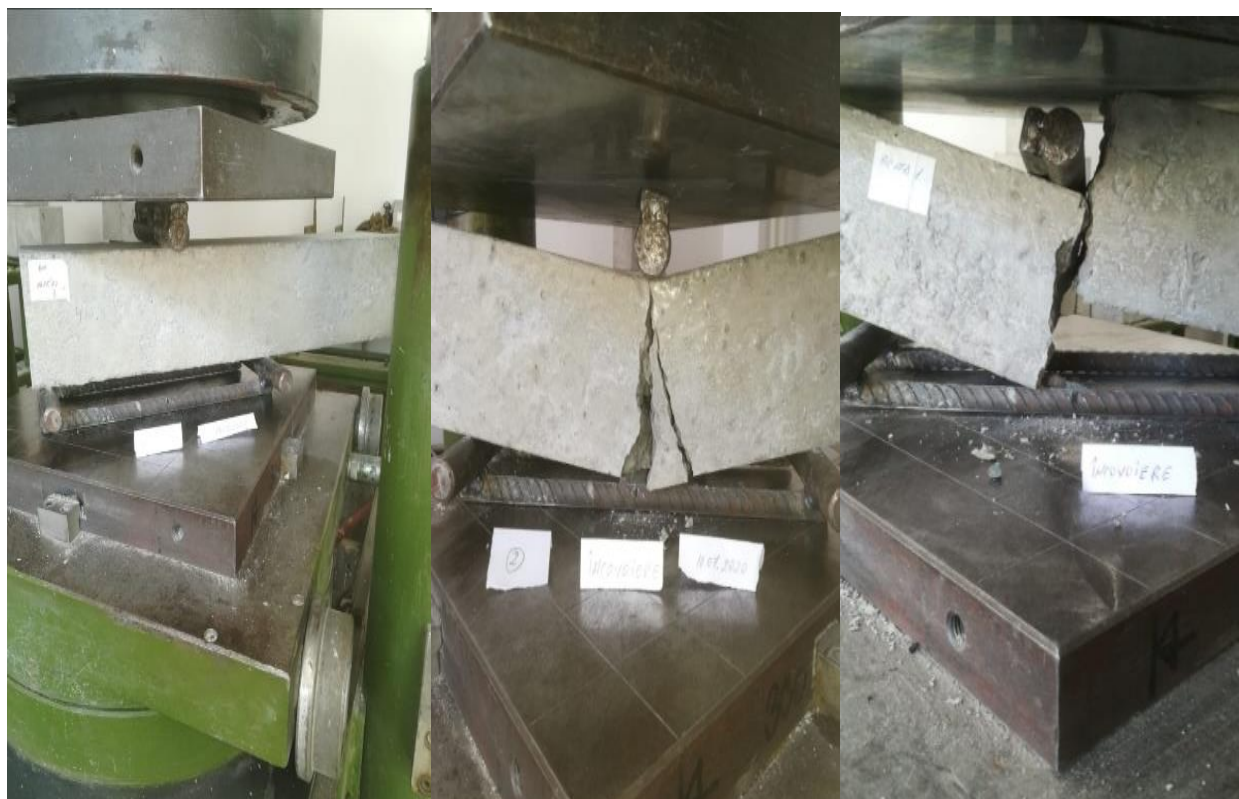
Fig. 3.5.2.3. Încercarea epruvetelor din beton cu ABRD la întindere prin încovoiere Valorile rezistenței la întindere prin încovoiere medie la 28 zile pentru probele de beton cu ABRD rezultate sunt prezentate în tabelul de mai jos:
