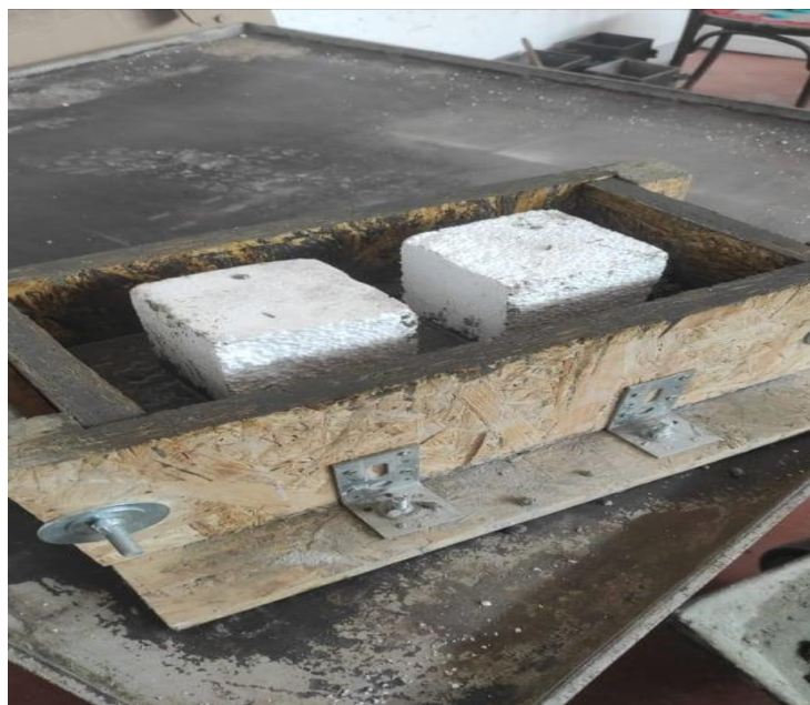
Fig.4.2.1.3. Cofraj pentru blocurile cu goluri
