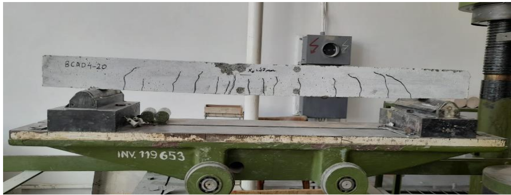
Fig.4.3.2.6. Mod de cedare grindă armată beton BCAD420
