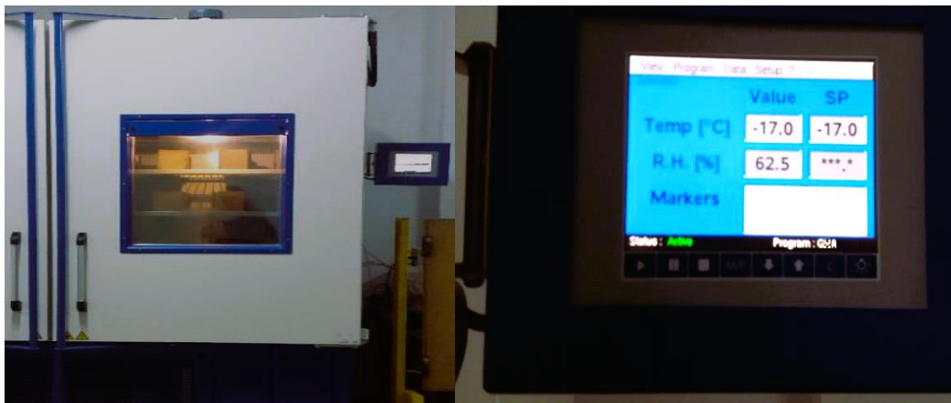
Fig.3.5.4.1 Supunerea probelor la 50 cicluri îngheț-dezgheț
