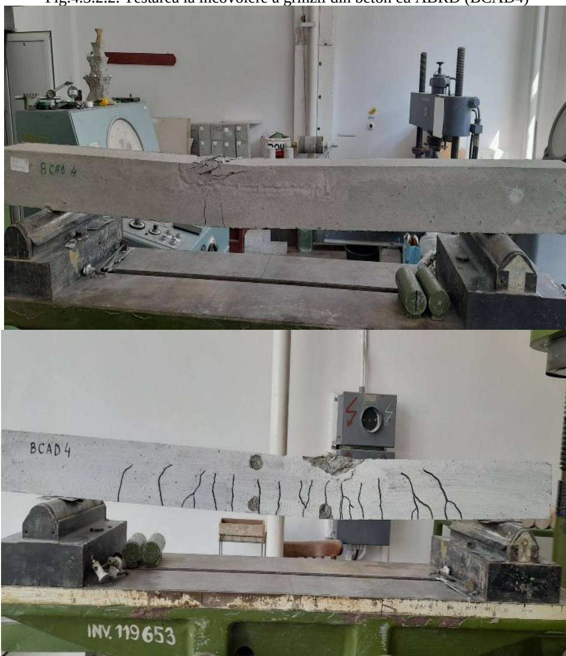
Fig.4.3.2.3. Mod de cedare grindă armată beton BCAD4
