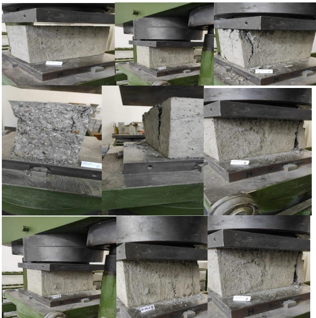
Fig. 4.2.2.1. Modul de cedare al bocurilor cu goluri din beton cu ABRD
