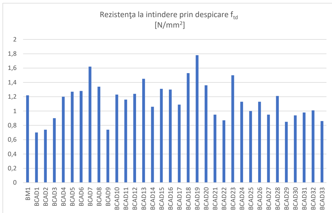
Fig. 3.5.2.6. Grafic cu valorile rezistenței la întindere prin despicare obținute de epruvetele din beton cu ABRD
