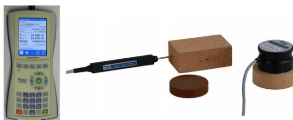
Figura 6.3 Dispozitiv portabil pentru determinarea proprietăților de transfer termic
