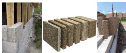
Figura 2.2 Blocuri de zidărie din beton de cânepă [81]
