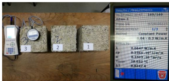
Figura 6.8 Determinarea experimentală a coeficientului de conductivitate termică [15]
