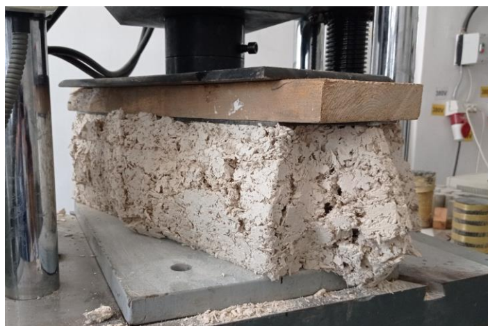
Figura 6.14 Bloc de zidărie – test de rezistență la compresiune
