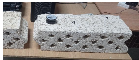
Figura 6.13 Măsurarea conductivității termice – pe direcția golului
