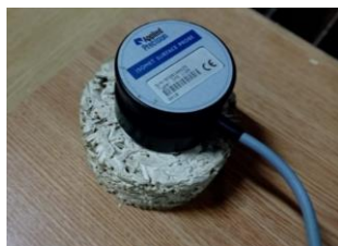
Figura 4.1 Măsurarea coeficientului de conductivitate termică [17]
