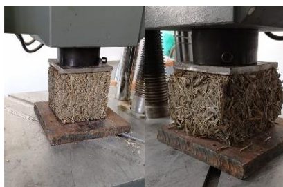
Figura 6.9 Test compresiune compoziție pentru turnarea monolită a pereților în cofraje pierdute [15]
