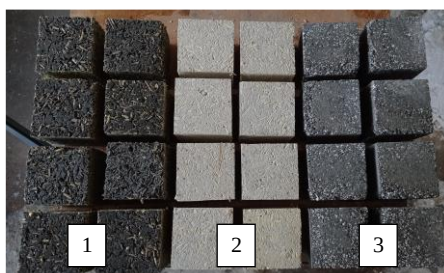
Figura 6.4 Epruvetele testate la compresiune : 1-SBC, 2-SBC-VHR și 3-SP
