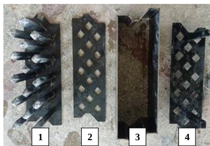
Figura 6.11 Matrița utilizată pentru turnarea blocurilor de zidărie
