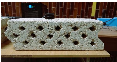
Figura 6.12 Măsurarea conductivității termice – între goluri
