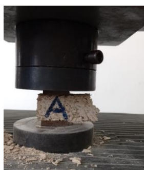
Figura 4.3 Încercarea la compresiune a capetelor de prismă [17]
