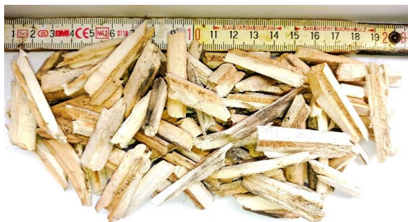
Figura 3.3 Agregate vegetale din lemn de cânepă tocat
