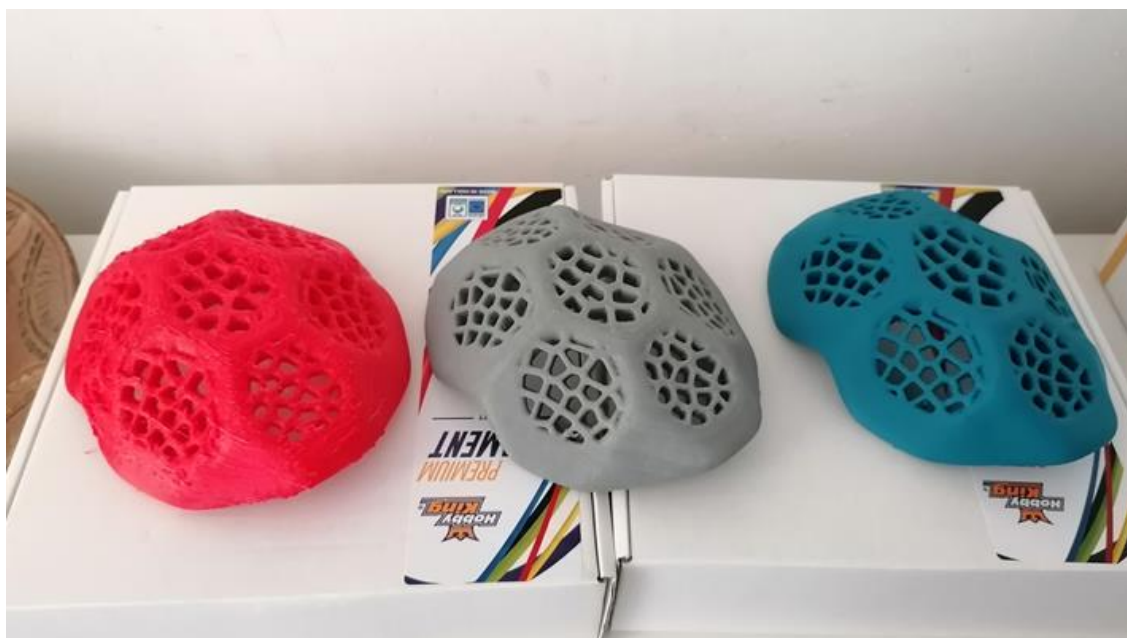
Figura 5. 8 Aspectul final al prototipurilor de genunchiere proiectate și realizate
