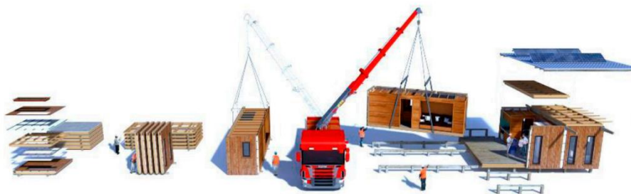
Figura 3.1. Procesul de instalare a unei structuri hibride realizată din panouri și structuri modulare (Bafo et al., 2016)
