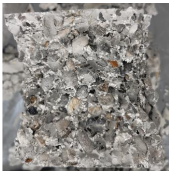
Figura 5.23. Distribuția particulelor de perlit în epruvete
