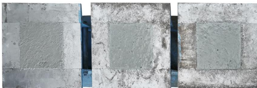
Figura 5.13. Probele cubice de beton cu perlit, cu latura de 150mm, proaspăt turnate în matrițe
