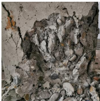
Figura 5.10. Distribuirea particulelor de cauciuc mărunțit în probele cubice
