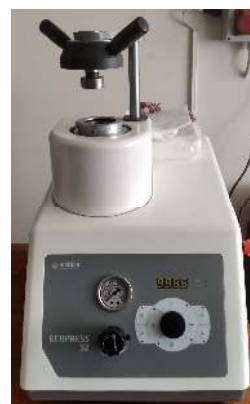
Figura 3.8. Mașina de debitat Metacut 302 (stânga) și mașina de înglobat Ecompress 52(dreapta)
