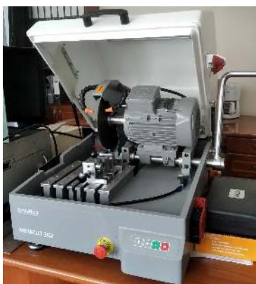
Figura 3.8. Mașina de debitat Metacut 302 (stânga) și mașina de înglobat Ecompress 52(dreapta)
