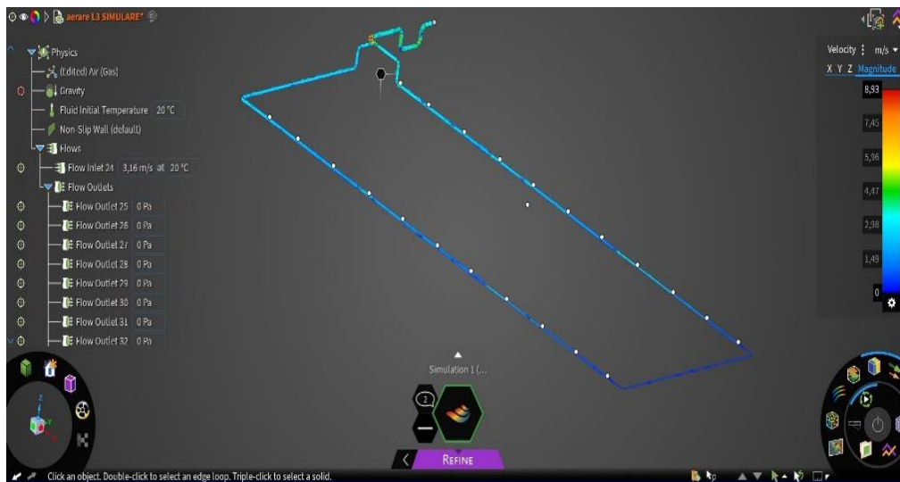
Fig. 6.9 – Modelare conductă de aer bioreactor nr. 3 ( v_{\min} = 3,16 \text{ m/s} )
