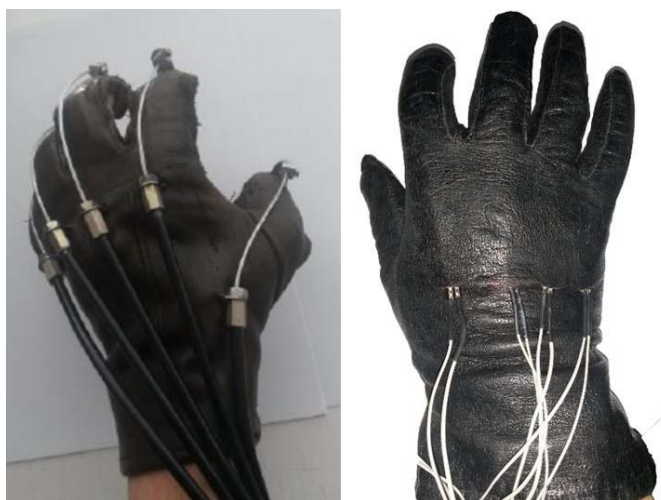
Figura 2.10 Mănușă cu tendoane flexibile (stânga) și mănușă echipată cu senzori flexibili pentru copierea mișcării degetelor (dreapta) – primul prototip MANUTEX - adaptare după [16]
