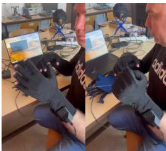
Figura 4.7 Calibrarea mănușii 5DT, stânga extensie, dreapta flexie
