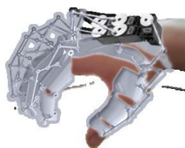
Figura 2.13 Arhitectura exoscheletului IHRG cu motoare servo – adaptare după [17]
