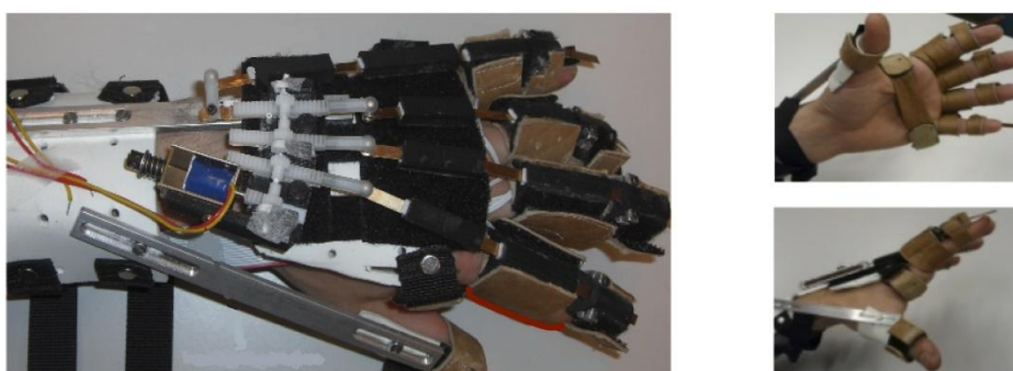
Figura 2.7 Orteză pasivă pentru reabilitarea mâinii utilizând FES [14]
