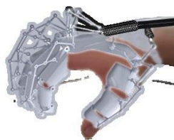
Figura 2.12 Arhitectura exoscheletului IHRG cu mușchi pneumatici – adaptare după [17]
