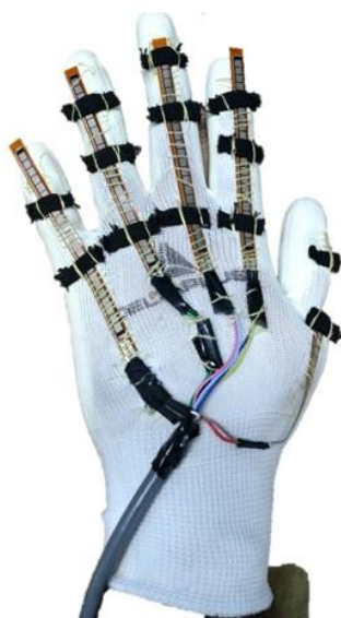
Figura 2.5 Mănușă cu senzori flexibili rezistivi – adaptare după [12]
