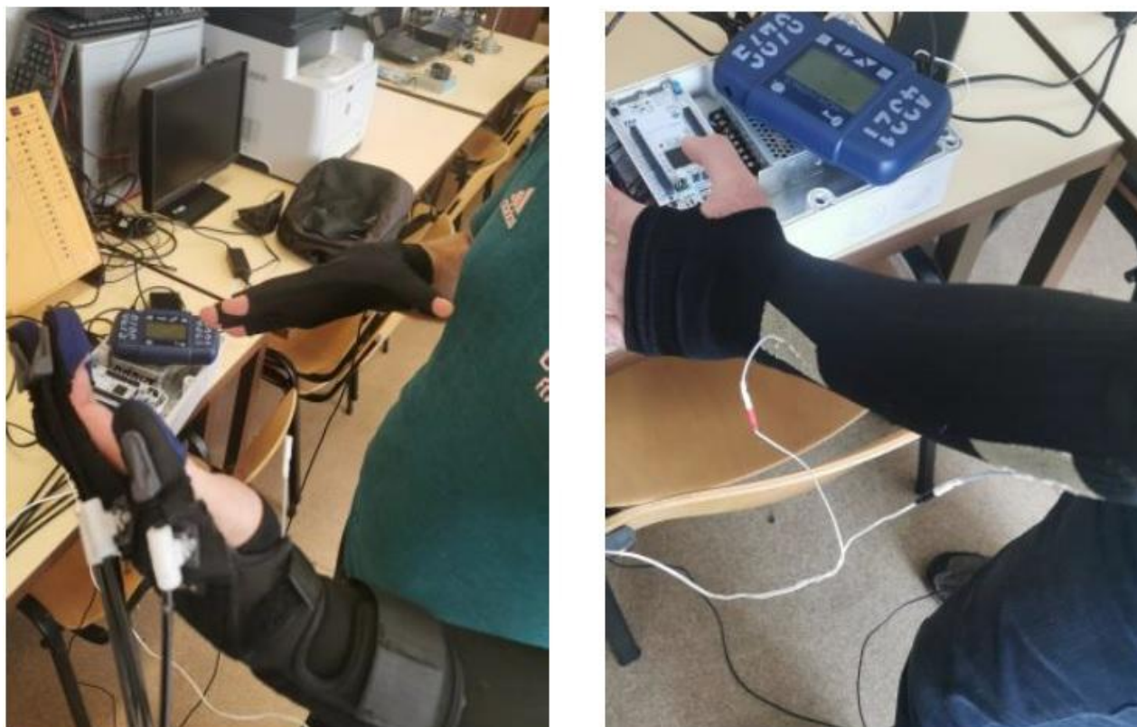
Figura 3.2 Sistemul MANUTEX cu exoschelet și mănușa FES pe mâna stângă și cu mănușa senzorială (stânga) și mănușa textilă cu electrozi (dreapta) pe mâna dreaptă – adaptare după [44]
