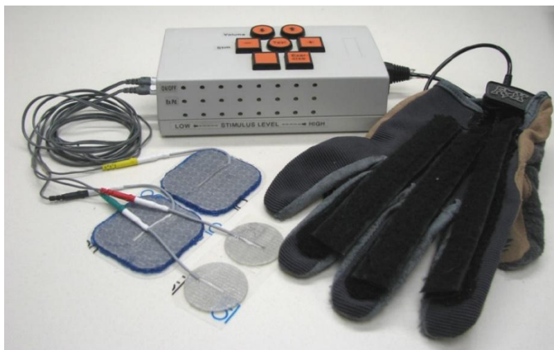
Figura 2.6 Sistemul CCFES cu stimulator, mănușă de comandă și electrozi - adaptare după [13]
