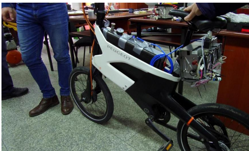
Figura 5.27. Bicicletă cu hidrogen propusă de C.En [17] 1 – Port de alimentare cu H_2 ; 2 – Rezervor de hidrogen; 3 – Fuel cell
