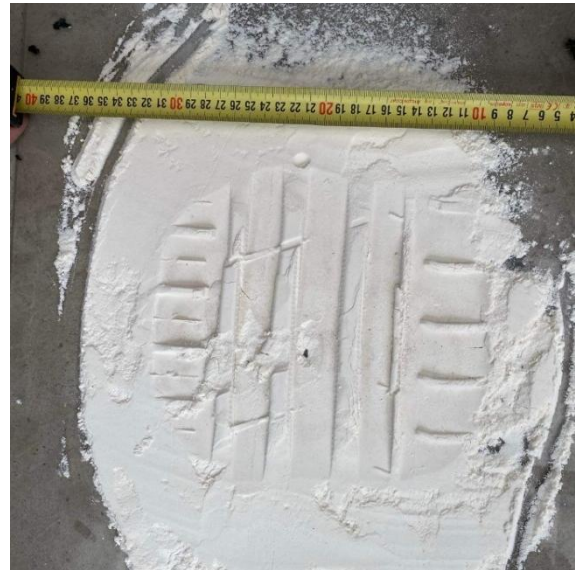
Fig. 5.9. Aria petei de contact obținută pe carosabil
