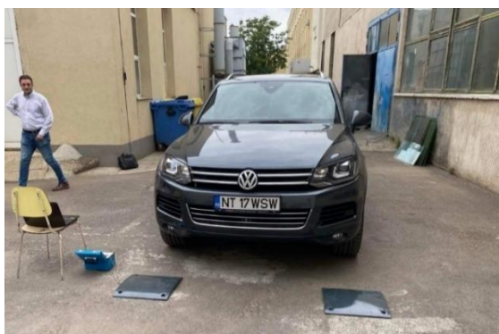
Fig. 5.4. Traversarea senzorilor cu autoturismul model Volkswagen Touareg si încarcarea-descarcarea statică repetată, cu ajutorul cricului
