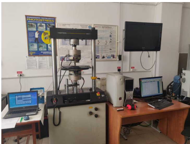
Fig. 4.11. Pulsatorul Instron 8801(mijloc), PC-ul pulsatorului (dreapta), puntea tensometrică Vishay P3 (în spatele laptopului) și achiziția datelor cu ajutorul laptopului (stânga)
