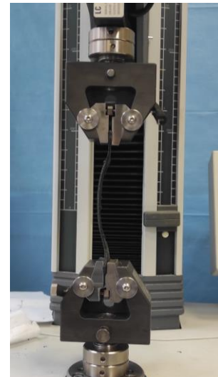
Fig. 38 - Prindere a epruvetelor la tracțiune
