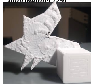
Fig. 55 - Printare planară fără suport [30]
