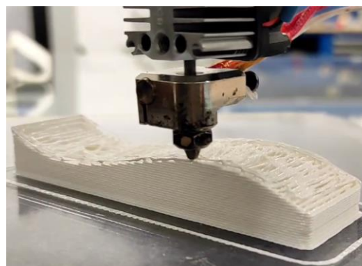
Fig. 33 - Printare nonplanară cu cap normal la platou
