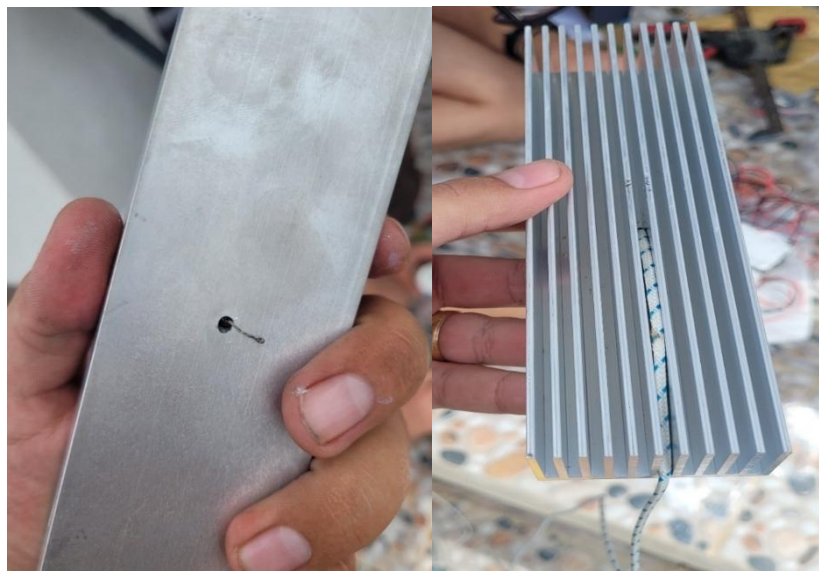
Fig. 4.12 Procesul de introducere a firului de termocuplu prin radiatorul de aluminiu
