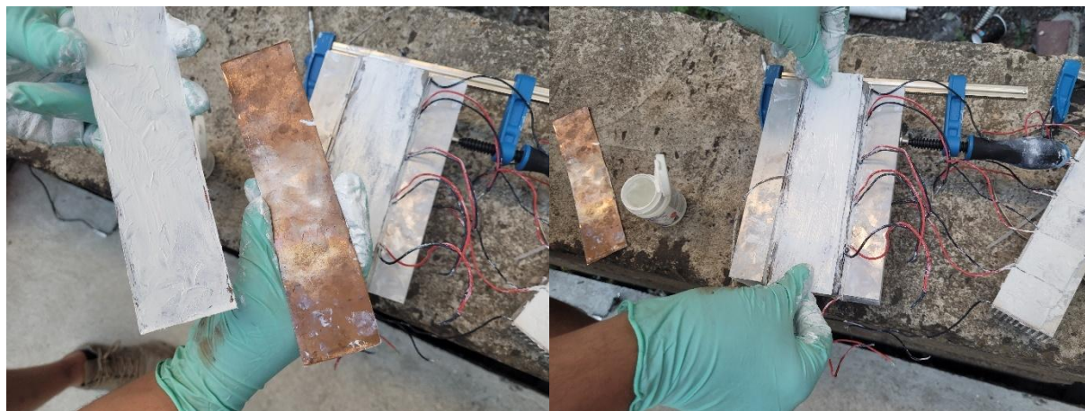
Fig. 4.10 Aplicarea stratului protector din cupru
