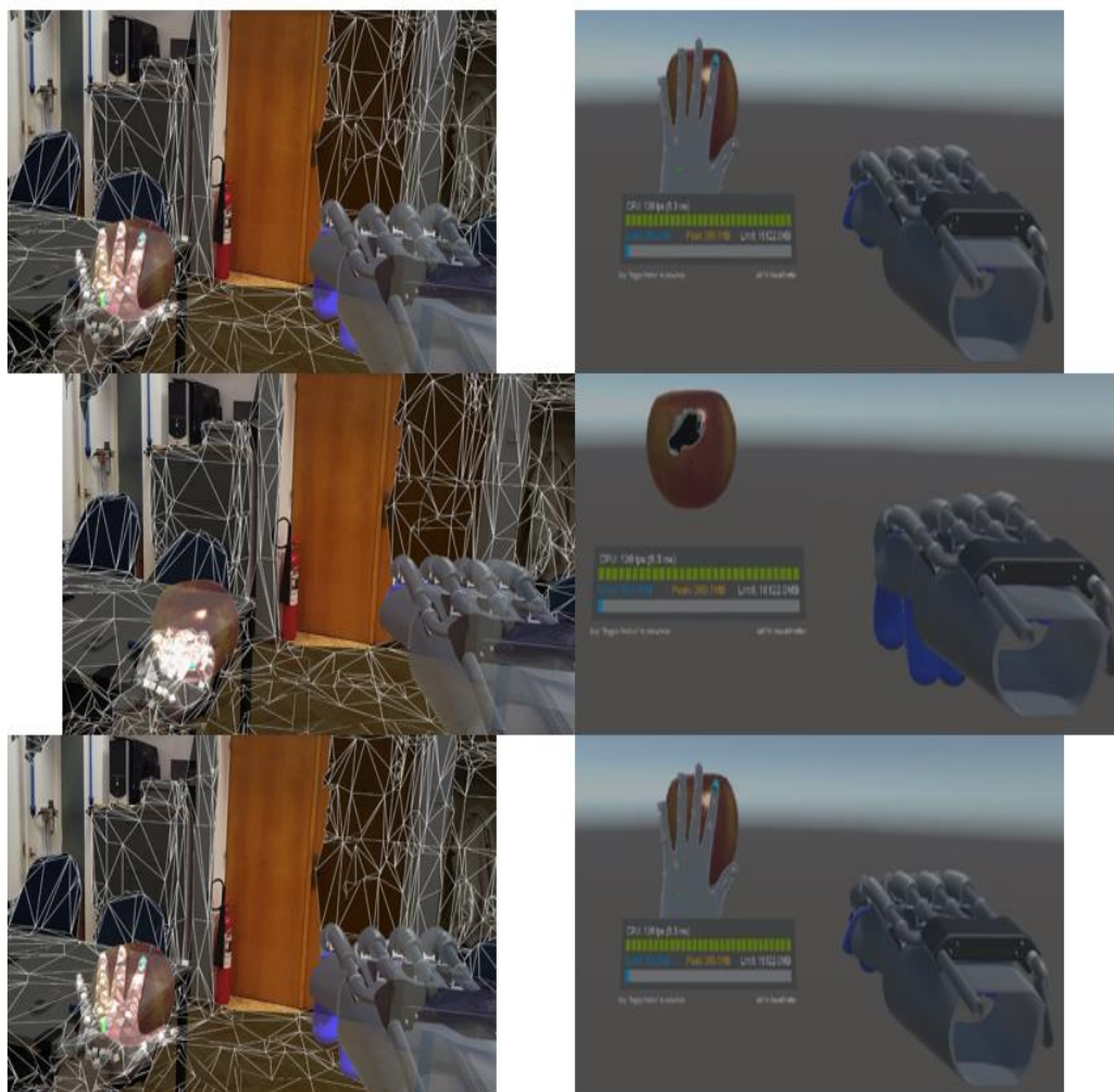
Figura 5.32. Cartografiere spațială realizată de dispozitivul HoloLens 2.
