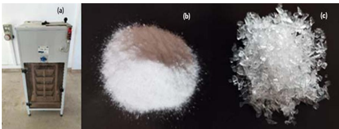
Figura II.2. Grntr 60 (a) [17], Sticlă reciclată și zdrobită (RCG) (b) și (c).
