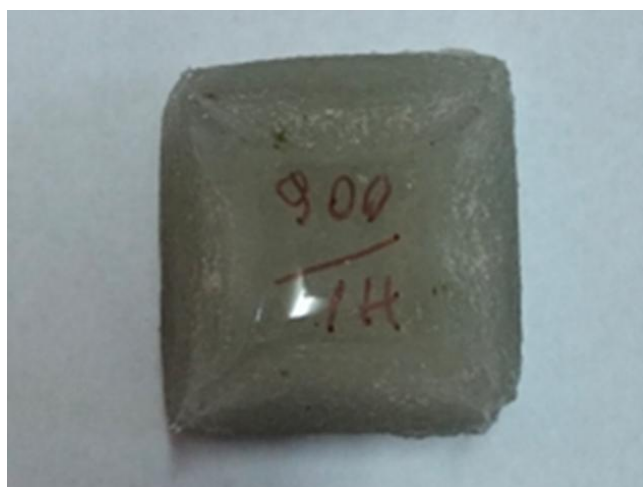
Figura IV.3. Eșantion SRC tratat termic la o temperatură de 900 °C și un prag de 60 min, dimensiunea granulelor de 0,15–2 mm, \text{TiO}_2/10\text{g} ,
