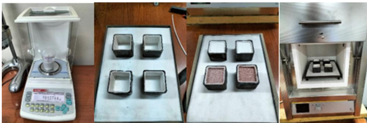
Figura II.17. Pregătirea probelor pentru tratament termic.
