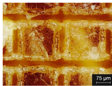
Fig. 4.7. Observarea microscopică a Arbofill Fichte texturat cu laser după testul de degradare:
