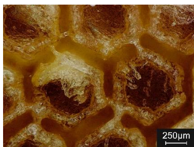
Fig. 4.7. Observarea microscopică a Arbofill Fichte texturat cu laser după testul de degradare:
