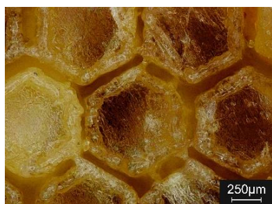
Fig. 4.8. Observarea microscopică a polimerului biodegradabil texturat cu laser după testul de degradare: (a) 6x_H; (b) 4x_S
