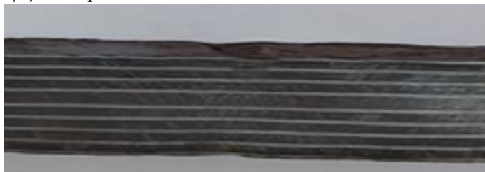
Figura 5.2. Probă forjată și pasivată din 26 fâșii
