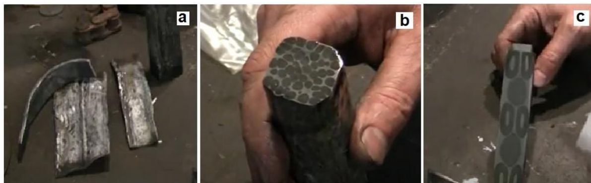
Fig. 1.12. a - Faza desfacerii casetei; b - Semifabricat din bile mici de rulment; c. semifabricat din piese mici (Crawford, 2017)
