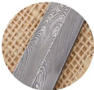
Fig. 1.2. Aspect caracteristic oțelului de Damasc forjat din pachet de benzi (Židzik, 2021)
