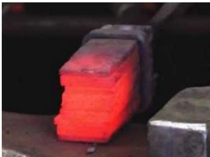
Fig. 1.4. Pachet de fâșii pentru forjare (Strobl et al., 2017)
