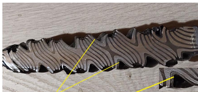
Fig. 5.7. Pachet rășucit din oțeluri inoxidabile
