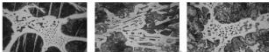
Fig. 1.9. Forme dendriculare ale ledeburite din aliajul cu 2,70%C (Sukhanov și Arkhangel'skii, 2016)
