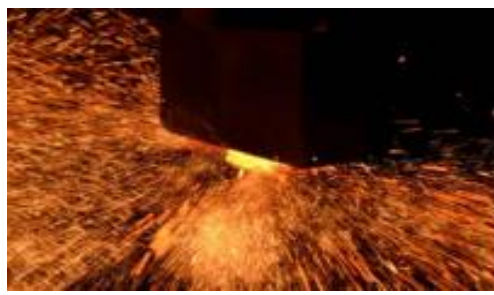
Fig. 1.7. Eliminarea fontei topite în timpul forjării (Strobl și Haubner 2016)
