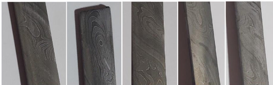
Fig. 5.6. Detalii de pe suprafețele probei cu 92 de benzi
