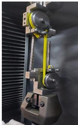
Figura 3. 8 Încercarea la tracțiune a cablului cu diametrul total de 12 mm
