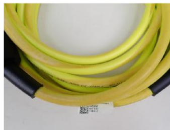
Figura 2. 3 Deteriorarea cablului prin modificarea culorii
