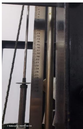
Figura 8. 5 Modul de citire a energiei pe scara gradată
