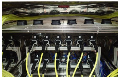
Figura 2. 6 Testarea cablurilor privind simularea fenomenelor de precipitații
