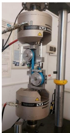
Figura 3. 5 Încercarea la tracțiune a cablului de 16 mm
