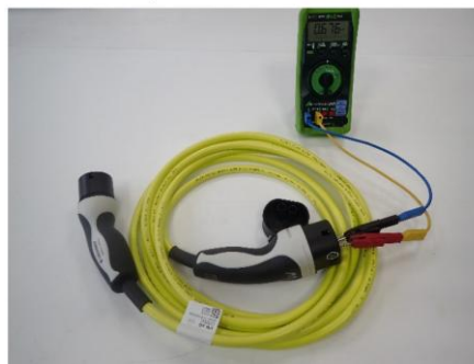
Figura 2. 5 Testare cu multimetru pentru verificarea continuității
