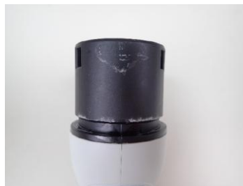
Figura 2. 2 Urme albe pe suprafața ștecherului, rezultat al înghețării
