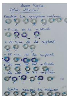
Figura 4. 1 Modul de prelevare a eșantioanelor din cablul cu diametrul exterior de 16 mm culoarea albastru
