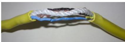
Figura 3. 17 Modul de rupere al probei cu diametrul total de 12 mm
