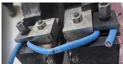
Figura 8. 6 Probă neruptă cu energia maximă de 300 J
