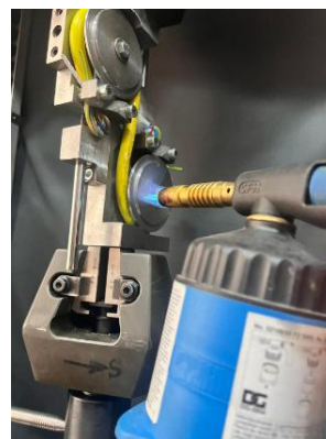
Figura 6. 2 Modul de încălzire inițială a cablului
