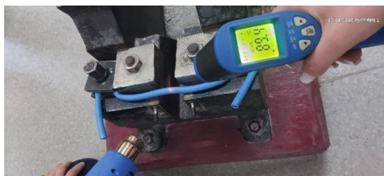
Figura 8. 7 Modul de încălzire și citire a temperaturii
