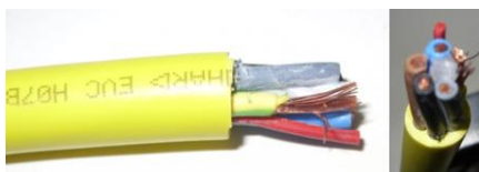
Figura 3. 16 Modul în care arată secțiunea probei după solicitare
