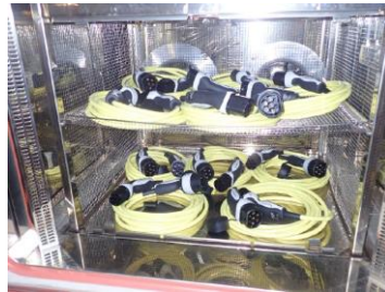
Figura 2. 1 Poziționarea cablurilor în simulatorul de temperatură cu șocuri
