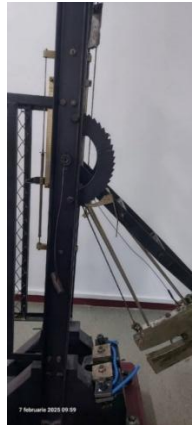
Figura 8. 3 Ciocanul pendul de tip Charpy
