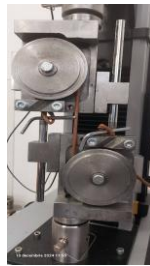
Figura 7. 4 Încercarea la tracțiune a cămășii interioare – montare în dispozitiv
