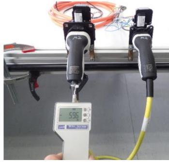
Figura 2. 4 Test de rezistență prin aplicarea unei forțe de tragere (încercare de a îndepărta cablul de ștecher)
