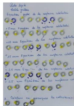
Figura 4. 2 Modul de prelevare a eșantioanelor din cablul cu diametrul exterior de 12 mm – culoarea galbenă
