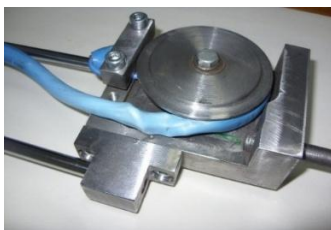
Figura 3. 15 Distrugere fără rupere totală a probei cu diametrul total de 16 mm, capătul de la o rolă și capătul de la cealaltă rolă
