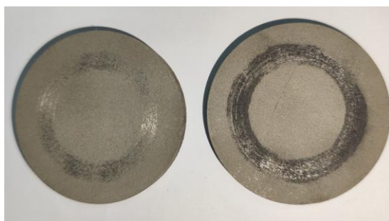
Figura 6.12. Aspectul celor 2 eșantionate testate la 10N.
