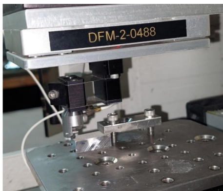
Figura 4.27. Imagini din timpul testelor de micro-scratch
