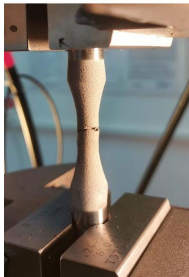
Figura 5.7. Imagine cu una dintre probele analizate, după rupere
