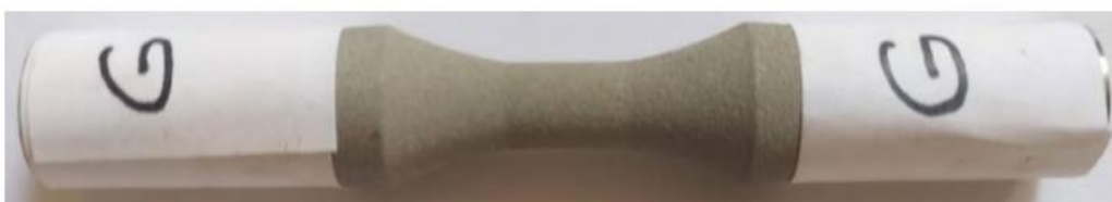
Figura 5.14. Proba G – fără rupere după peste 5 mil. cicluri ( \sigma = 318 MPa, N = 5000208 cicluri)
