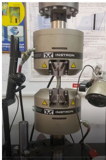
Figura 5.6. Montajul celor două camere web pentru observații în timp real.
