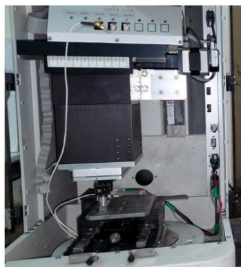
Figura 4.27. Imagini din timpul testelor de micro-scratch
