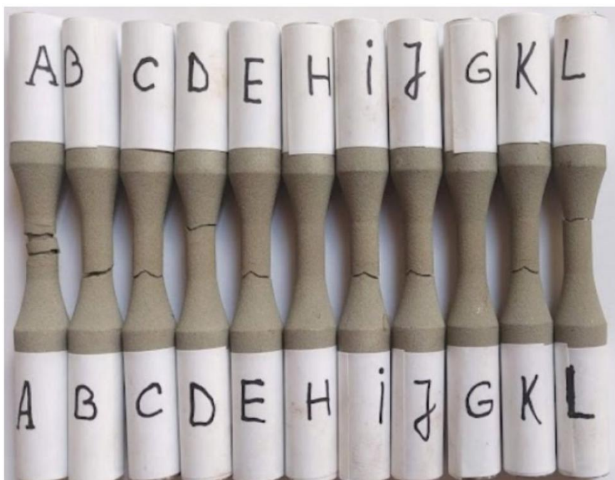
Figura 5.9. Aspectul probelor după derularea testelor de rupere la oboseală
