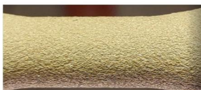
Figura 5.15. Vedere macroscopică a suprafeței probei G (4340) după 5 milioane de cicluri
