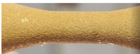
Figura 5.17. Vedere macroscopică a suprafeței eșantionului H (4340) după 5 milioane de cicluri
