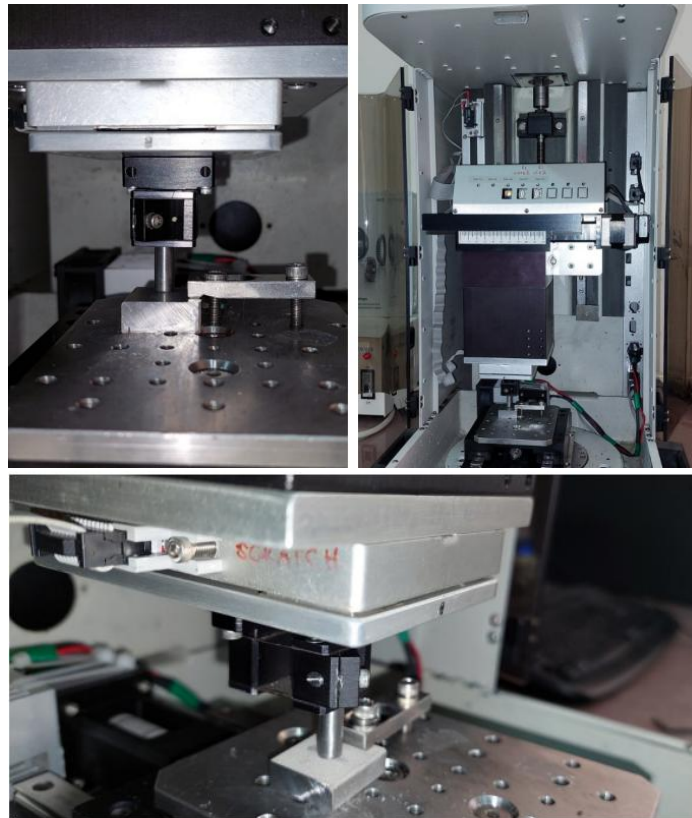
Figura 6.9. Imagini din timpul testelor de frecare cu mișcare liniară
