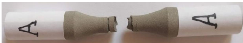
Figura 5.1. Montajul probelor pentru testele de tracțiune statică
