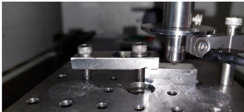
Figura 4.9. Montaj specific pentru realizarea testelor de micro-indentare.
