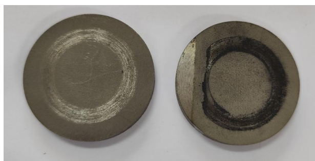
Figura 6.13. Aspectul celor 2 eșantionate testate la 20N.
