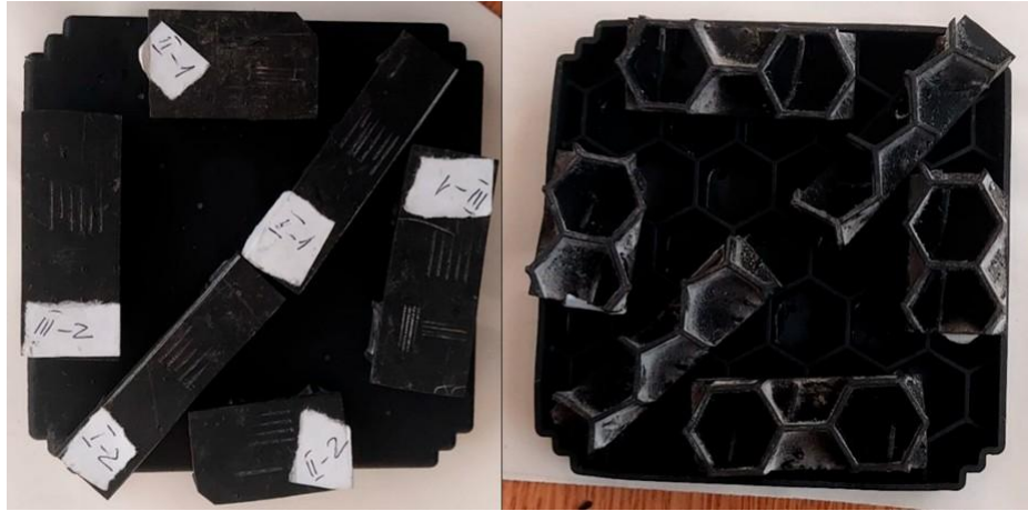
Probe pentru testul de zgâriere decupate din carcasa de referință
