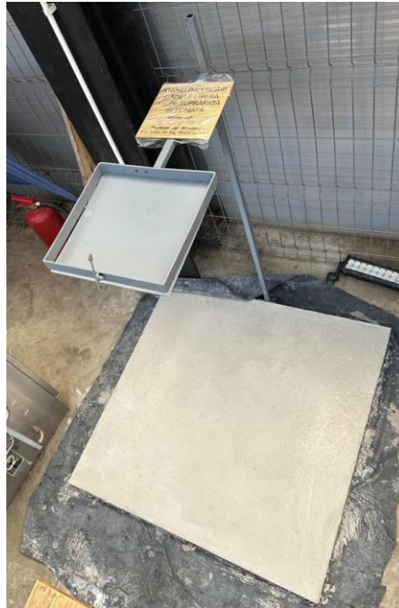
Stand de încercări cădere liberă de la 1 metru pe suprafață betonată
