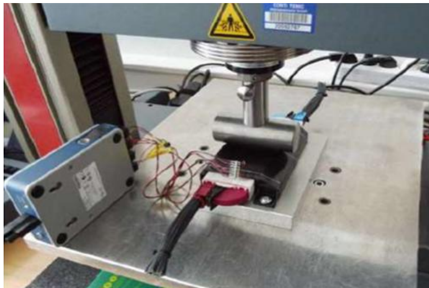
Test generic cu forță externă cu cilindru metalic având 40 mm diametru
