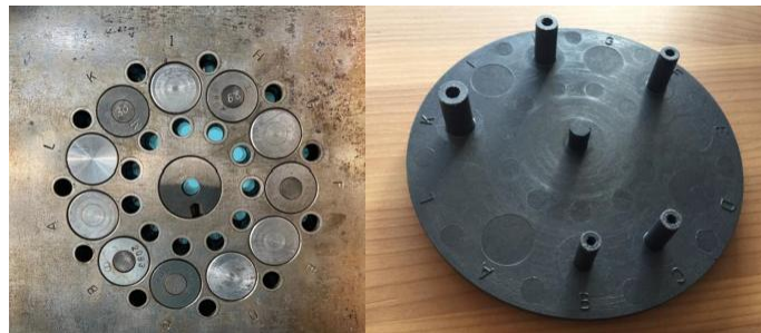
Matrița de testare a șurubului (stânga) și piesa (dreapta)
