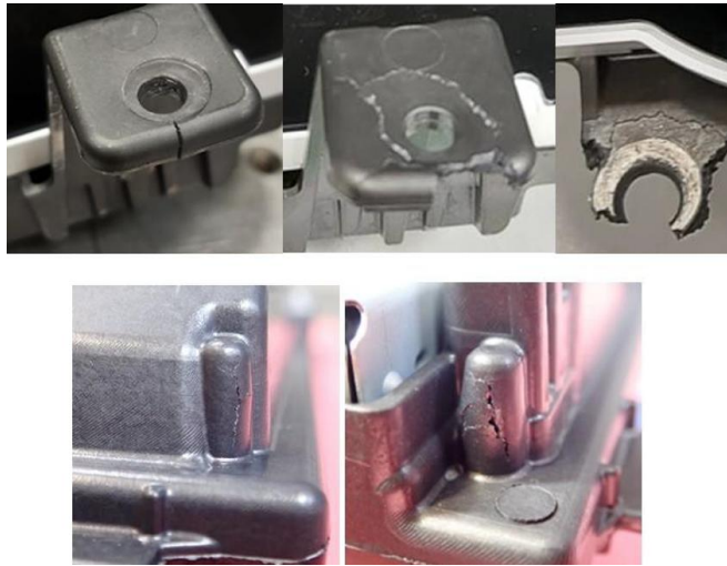
Proiectări necorespunzătoare pentru piese din plastic conductiv termic
