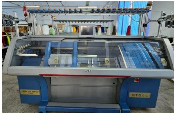
Figura 4.2. Imagine generală a mașinii electronice de tricotat Stoll CMS 330 TT, finețe 7.2 E
