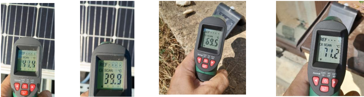
Figura 5.18: T_{PVT} înainte de răcire
