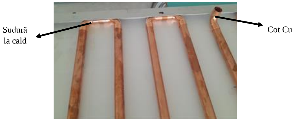
Figura 5.6. Fixarea sistemului de răcire
