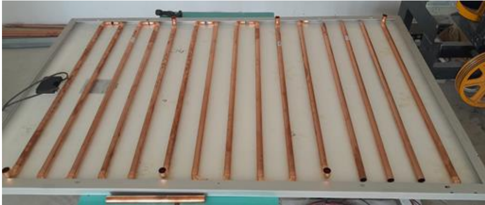
Figura 5.5. Stand experimental (execuție) – vedere de ansamblu al PVT
