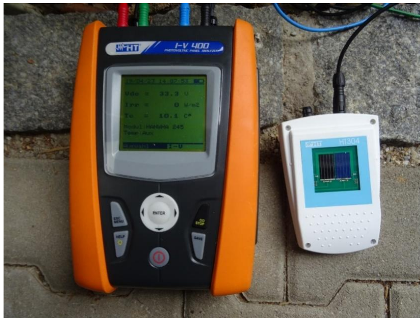
Fig 0.17 Aparat de măsurare curbă caracteristică HT IV-400 cu senzor de radiații
