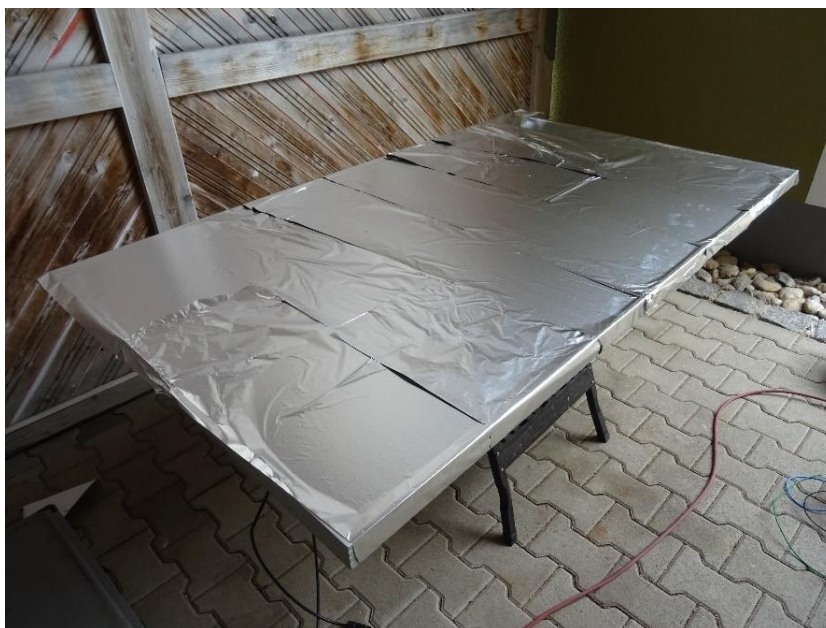
Fig 0.15 Modul fotovoltaic acoperit cu folie de aluminiu
